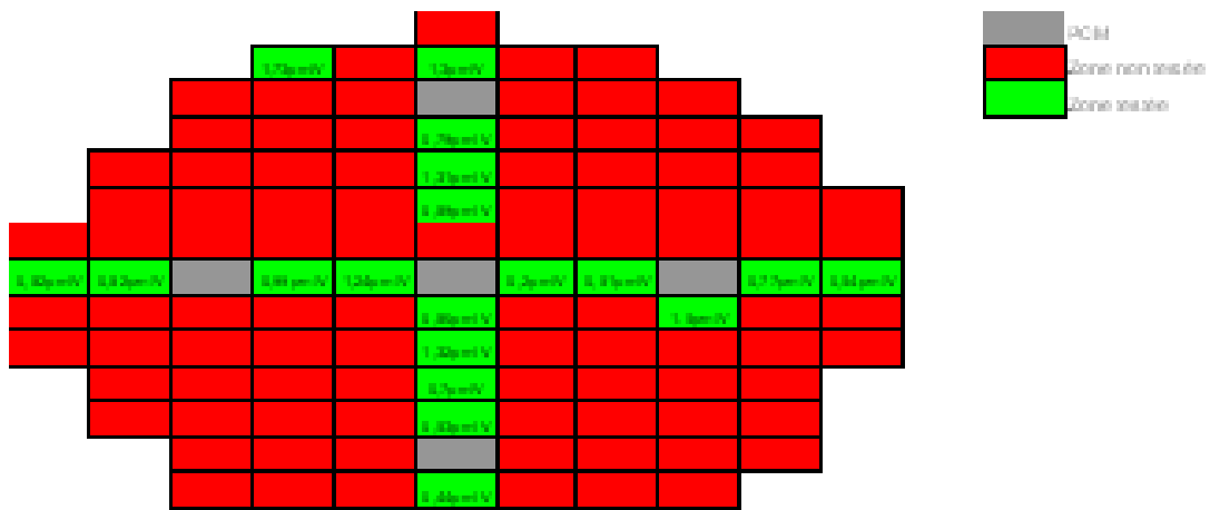
FIGURE 3.27: Cartographie du wafer n°1 dont la couche d'AlN a été déposée par NXP SEMICONDUCTORS.
