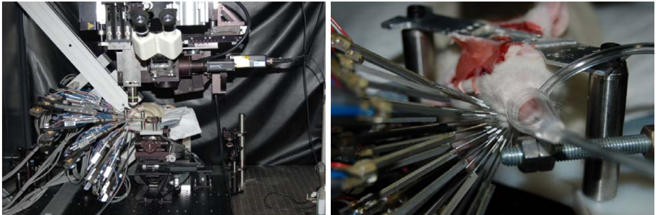
Figure III.7 : Matrice de stimulation implémentée sur le microscope à 2 photons A gauche, matrice de stimulation incorporée au microscope à deux photons. A droite, zoom au niveau des vibrisses où convergent l'ensemble des stimulateurs.
