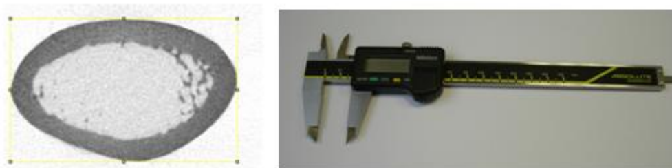
Figure 42 : Mesure des diamètres internes et externes des os avec le logiciel Image J, et mesure de la hauteur du fémur avec un pied à coulisse.
