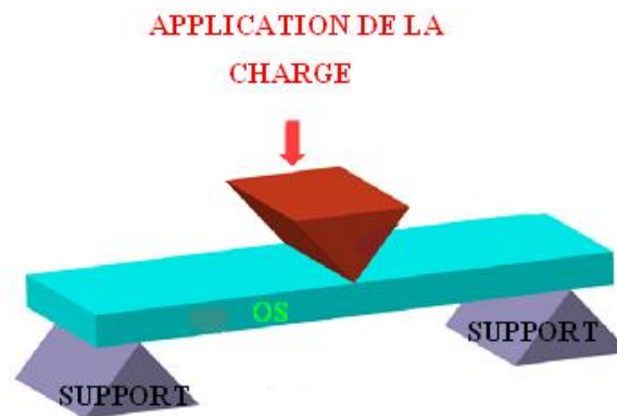
Figure 43 : Schéma d'un test de flexion 3 points.
