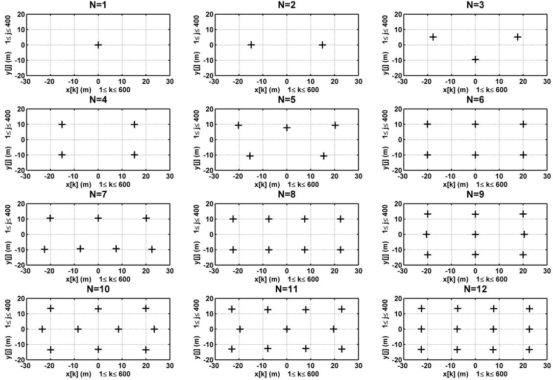
FIGURE 4.2 – Résultats du positionnement optimal des antennes distribuées dans une architecture indoor de dimensions 60 m  $\times$  40 m.
