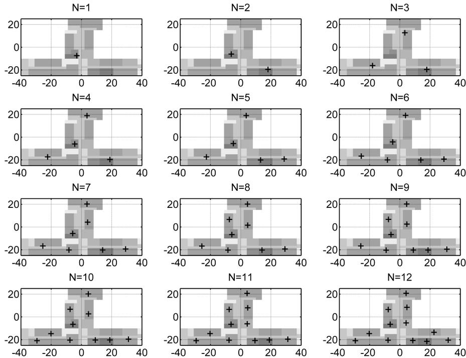
FIGURE 4.12 – Positions des antennes distribuées dans l’environnement considéré, obtenu à partir de l’algorithme PAD.
