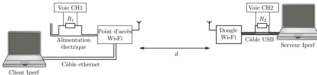
FIGURE 3.6 – Protocole expérimental de la mesure de puissance.
