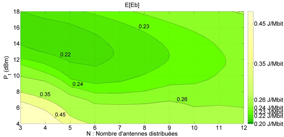
FIGURE 4.16 – Évolution de l'espérance spatiale de l'énergie par bit en fonction du nombre d'antennes distribuées  $N$  et de la puissance totale rayonnée  $P_t$ .
