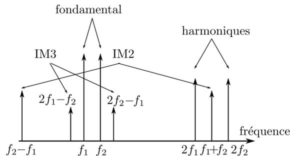
FIGURE 2.4 – Mise en évidence des produits d'intermodulation.
