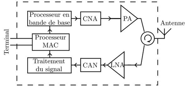
FIGURE 3.4 – Diagramme simplifié d'un module Wi-Fi [105].
