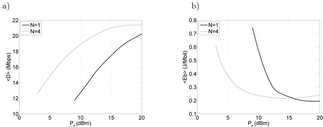
FIGURE 3.12 – Comparaison du débit moyen effectif a) et de l'énergie par bit moyenne b) sur l'ensemble de l'espace considéré pour une architecture mono-antenne ( $N = 1$ ) et une architecture comprenant quatre antennes distribuées ( $N = 4$ ).
