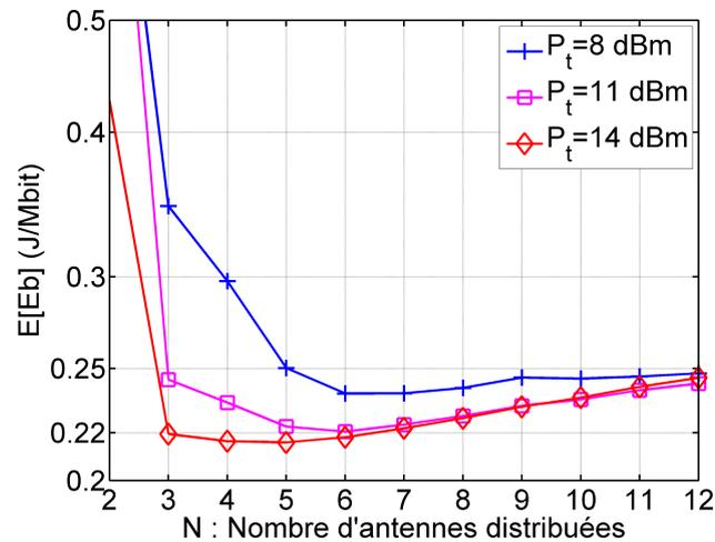
FIGURE 4.15 – Évolution de l'espérance spatiale de l'énergie par bit en fonction du nombre d'antennes distribuées pour des puissances totales rayonnées de 8, 11 et 14 dBm.
