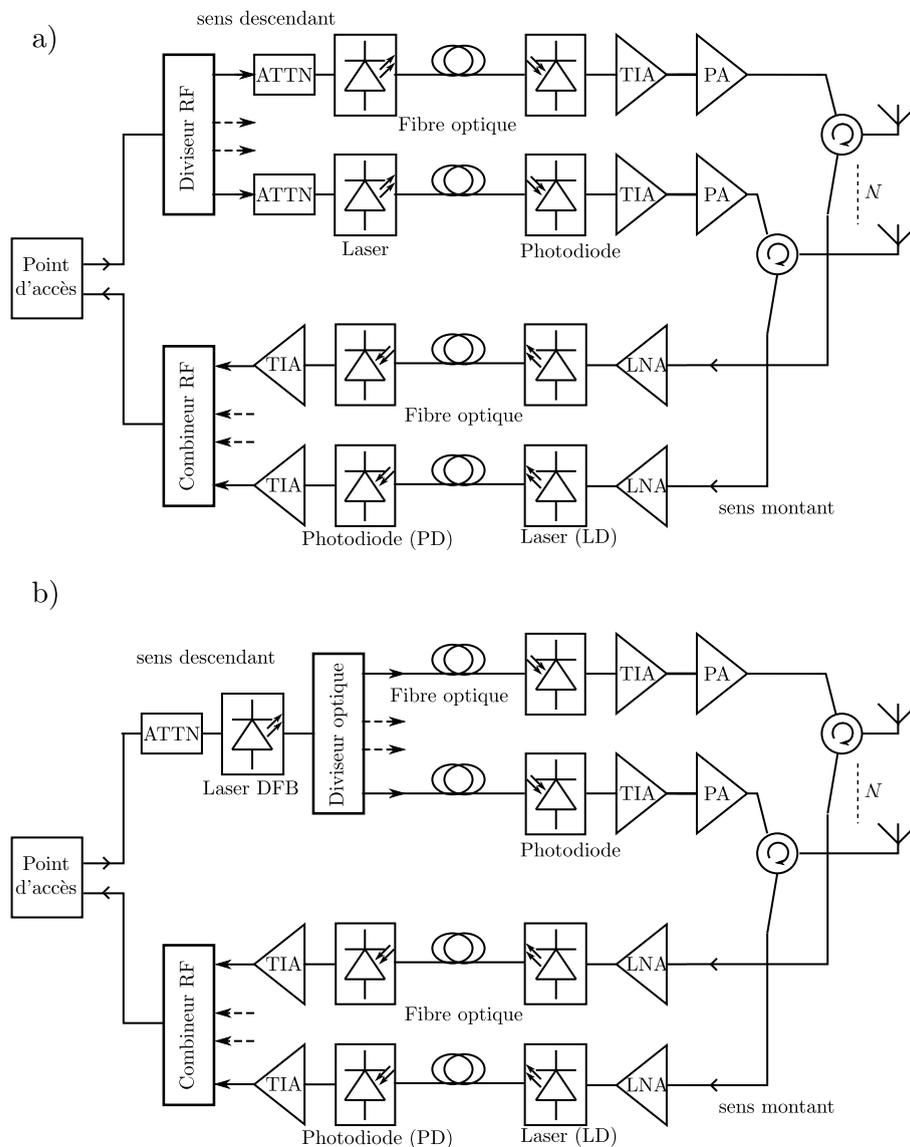
FIGURE 2.9 – Architectures de la chaîne optique pour un réseau comportant  $N$  antennes distribuées. L'architecture a) utilise un diviseur et un combineur RF tandis que la b) introduit un diviseur optique et un combineur RF.
