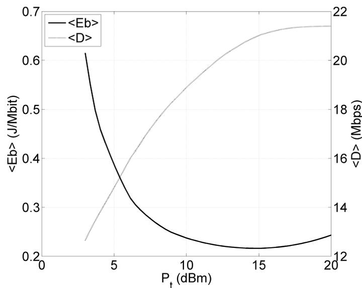
FIGURE 3.10 – Évolution de l'énergie par bit moyenne et du débit moyen en fonction de la puissance rayonnée par les quatre antennes distribuées.
