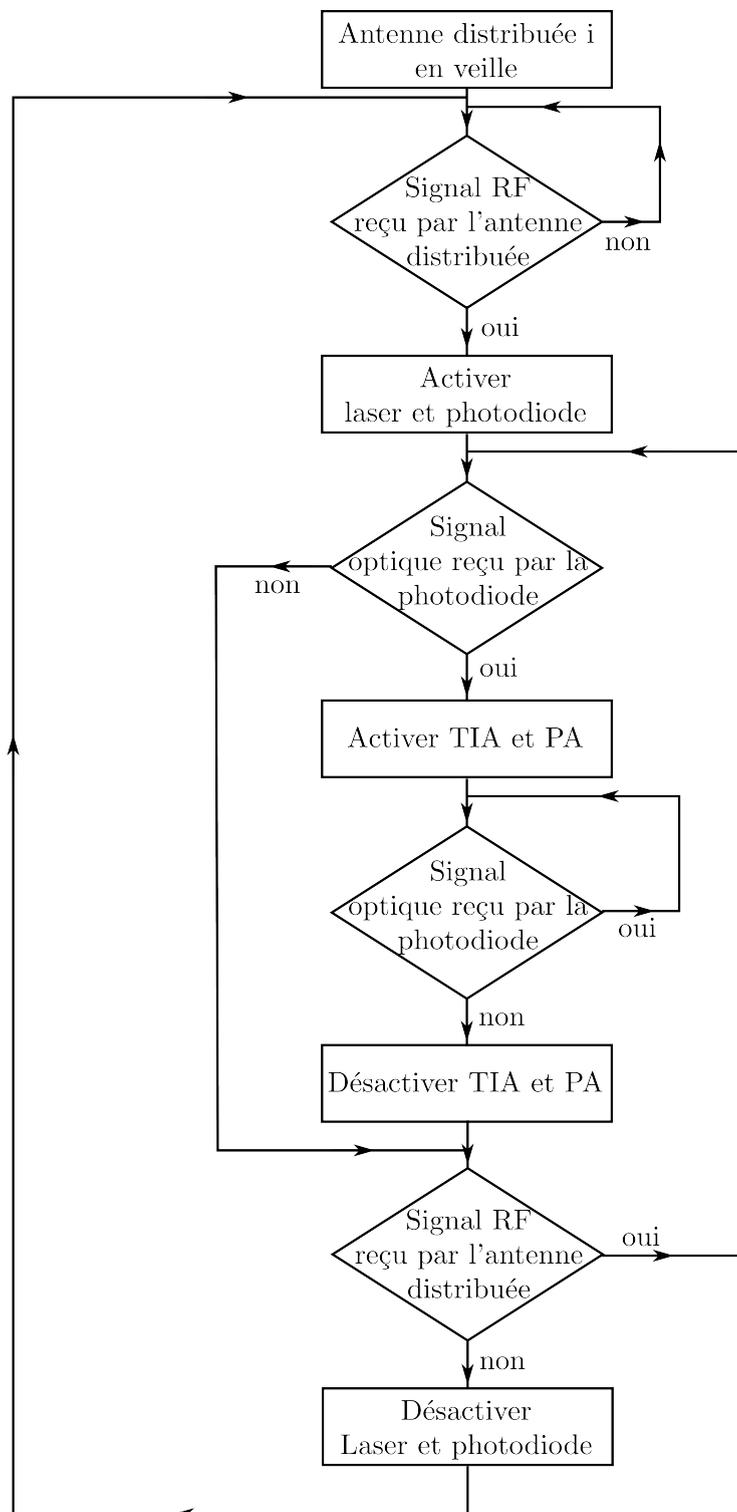
FIGURE 5.2 – Présentation de l’algorithme permettant la mise en veille des antennes distribuées : MEVAD2.
