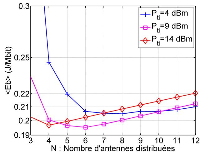
FIGURE 5.5 – Évolution de l'énergie par bit moyenne en fonction du nombre d'antennes distribuées pour des puissances rayonnées par les antennes distribuées égales à 4, 9 et 14 dBm.
