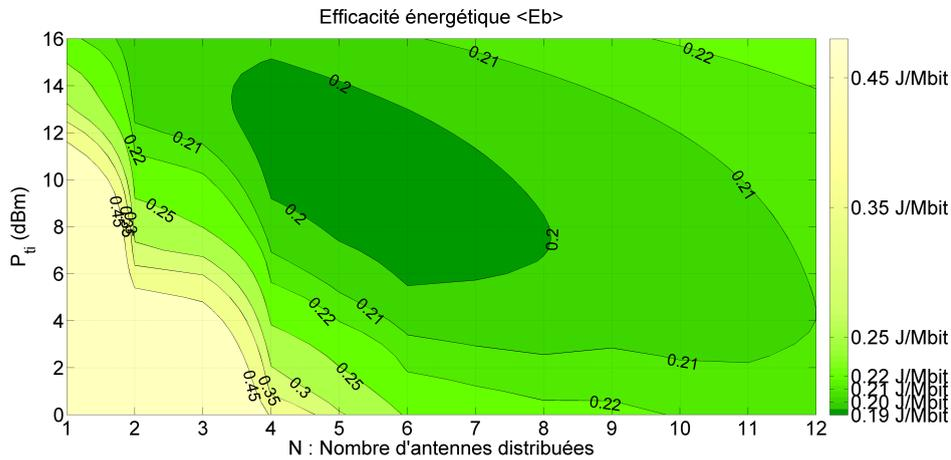
FIGURE 5.7 – Évolution de l'énergie par bit moyenne en fonction du nombre d'antennes distribuées  $N$  et de la puissance rayonnée par antenne  $P_{ti}$ .
