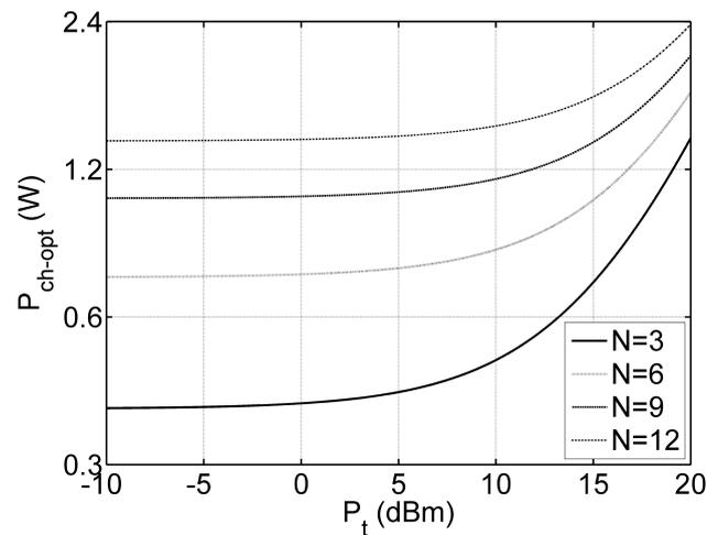
FIGURE 2.11 – Puissance consommée par l’ensemble de la chaîne optique en fonction de la puissance rayonnée pour des nombres d’antennes distribuées différents.
