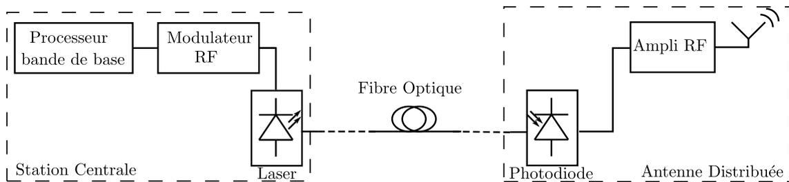
FIGURE 1.6 – Structure d'une liaison Radio-sur-Fibre (RoF).
