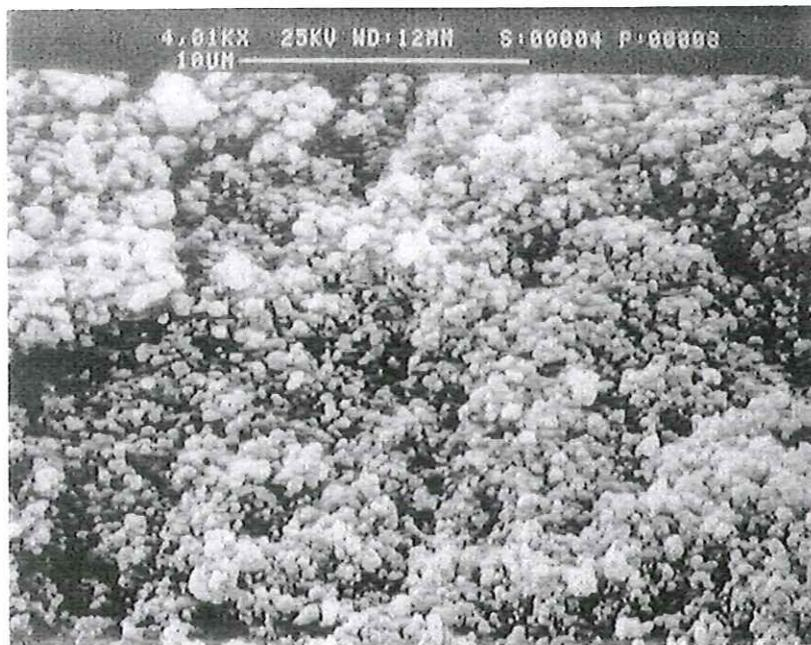
Figure 4 : Céramique d'alumine Al(D)-41.2 (Desmarquest). Température de frittage : 1073 K. Porosité : 41.2 %.
