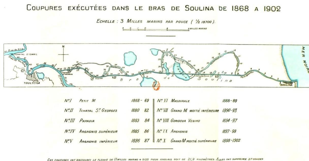
**Figure 36 :** Série de recoupements réalisés par la CED dans le bras de Sulina entre 1868 et 1902.
