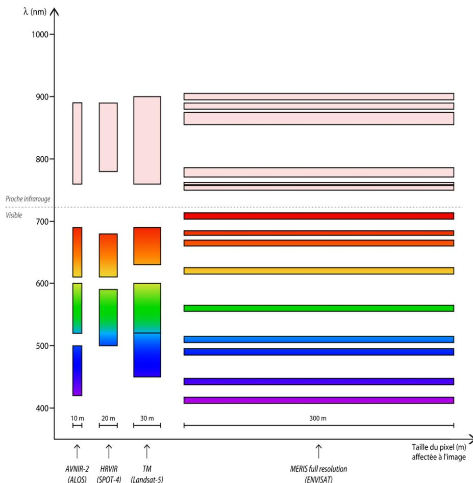
**Figure 62 :** Représentation graphique (proportionnelle) des résolutions spectrales et spatiales des capteurs optiques utilisés dans la présente recherche (AVNIR-2, HRVIR, TM et MERIS).
