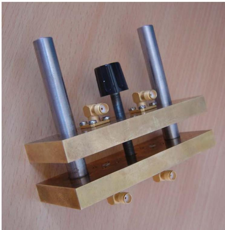
**Fig. 4- 1 : Banc de caractérisation de matériau**
