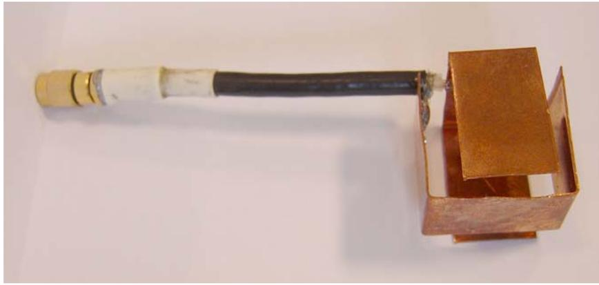
**Fig. 3- 12 : Antenne cube réalisée**
