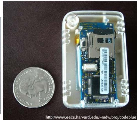
**Fig. 1- 32 : Plate-forme Shimmer d'Intel**
