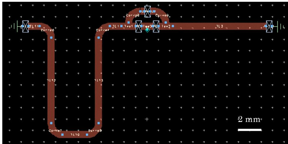
**Fig. 3- 68 : Layout du circuit déphaseur pour deux ports**
