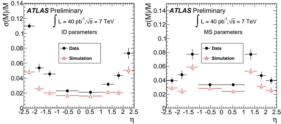
FIGURE 3.8: Résolution  $\frac{\sigma(M)}{M}$  de la masse du boson  $Z$  en fonction de la gamme en pseudo-rapidité des deux muons pour le trajectographe interne à gauche pour le spectromètre à muons à droite. Les cercles noirs représentent les données 2010 et les triangles rouges la simulation.
