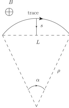
FIGURE 3.7: Représentation de la trajectoire d'une trace dans le détecteur à muon.  $B$  représente le champ magnétique du spectromètre,  $s$  représente la flèche de la trace,  $\rho$  est le rayon de courbure et  $L$  est la distance entre deux points périphériques.
