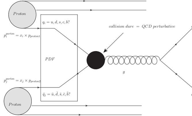
FIGURE 1.6: Schéma de la production de deux quarks quelconques au LHC. La partie PDF fait référence à  $\sum_{i,j=q,\bar{q},g} \int dx_i dx_j f(x_i, Q^2) \bar{f}(x_j, Q^2)$  quand la partie notée QCD perturbative représente  $\hat{\sigma}_{ij \rightarrow X}(x_i, x_j)$ .
