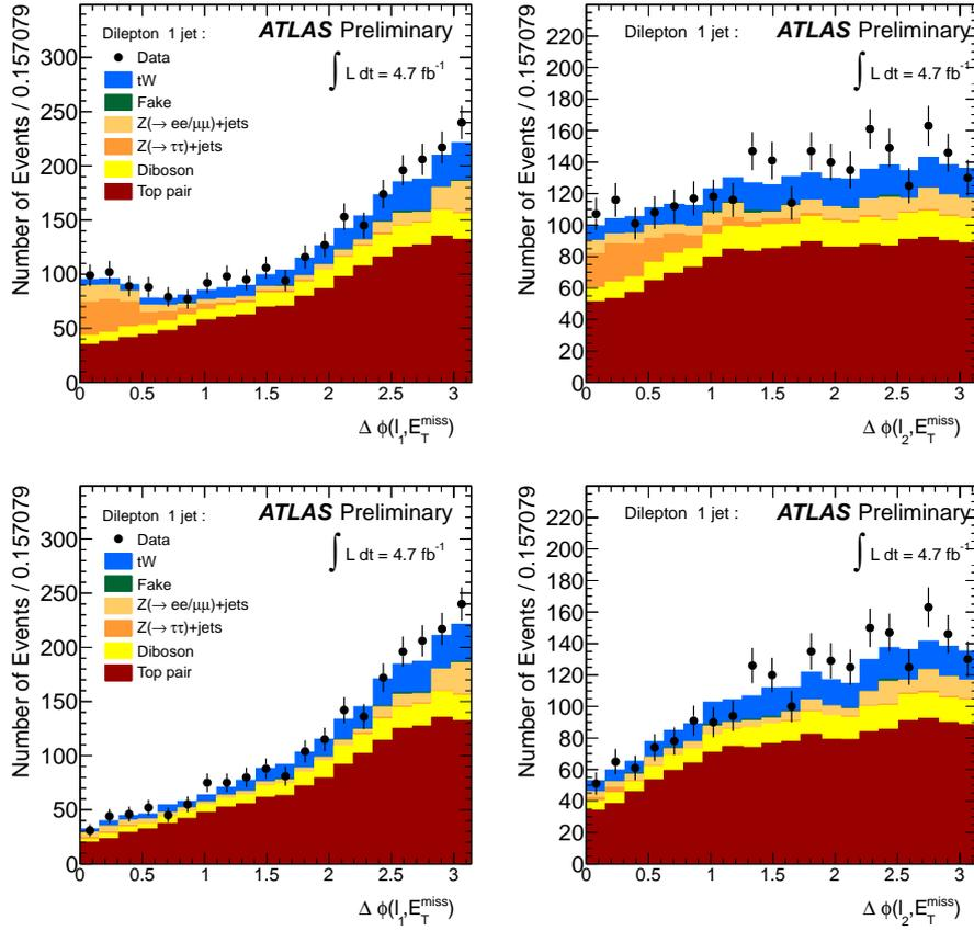
FIGURE 6.1: Distribution dans le lot à 1 jet de  $\Delta\phi(l_1, E_T^{miss})$  et  $\Delta\phi(l_2, E_T^{miss})$  dans la simulation comparées aux données avant (en haut) et après coupure (en bas) sur  $\Delta\phi(l_1, E_T^{miss}) + \Delta\phi(l_2, E_T^{miss}) > 2.5$  utilisée pour la réduction du fond  $Z(\rightarrow \tau\tau) + jets$ .
