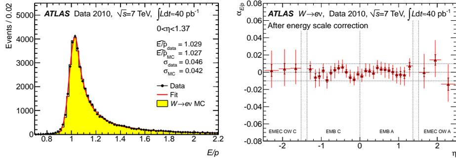
FIGURE 3.3: A gauche : Mesure du ratio  $E/p$  pour la calibration en énergie des électrons dans le baril du calorimètre électromagnétique. Les points noirs sont les données, en jaune est représentée la simulation et en rouge le meilleur ajustement par une Crystal Ball. A droite : Valeur des facteurs correctifs  $\alpha_{E/p}$  mesurés dans les événements  $W \rightarrow e\nu$ .
