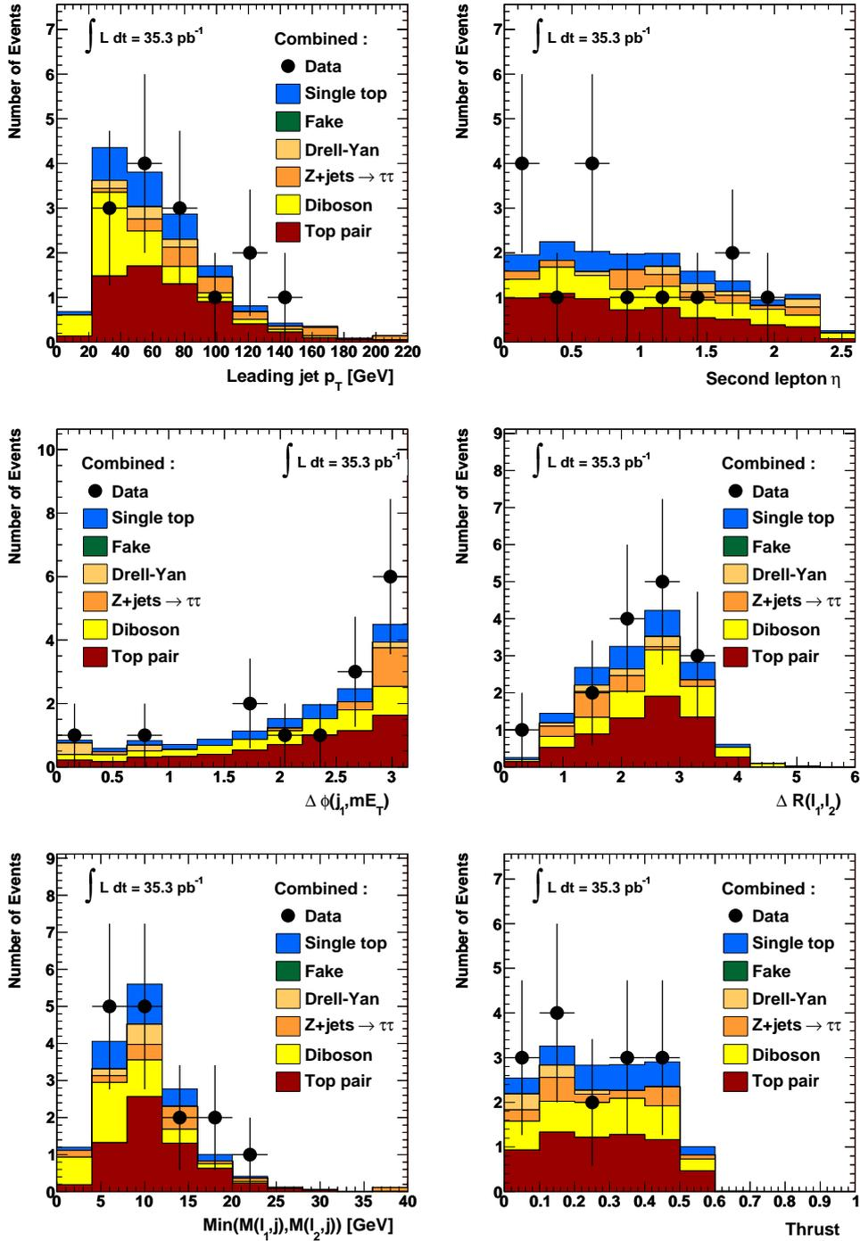
FIGURE 5.11: Distribution pour les canaux combinés  $ee + \mu\mu + e\mu$ . De gauche à droite :  $p_T$  du jet de plus haut  $p_T$ ,  $\eta(l_2)$ ,  $\Delta\Phi(j_{et}, mET)$ ,  $\Delta R(l_1, l_2)$ ,  $\text{Min}(M_{l_1j}, M_{l_2j})$ ,  $Thrust$
