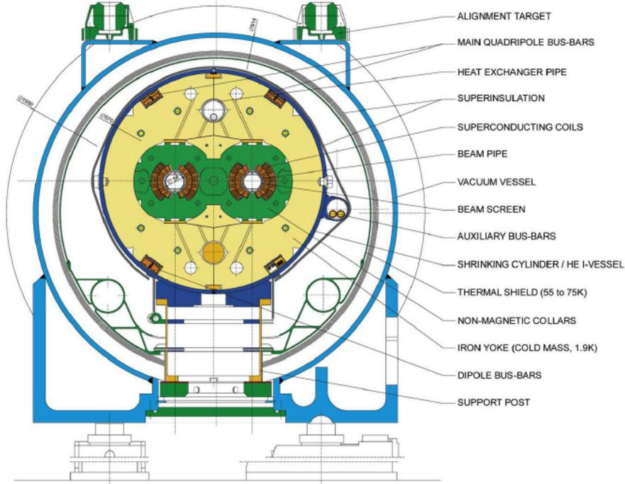
FIGURE 2.2: Coupe transverse détaillée d'un dipôle du LHC.
