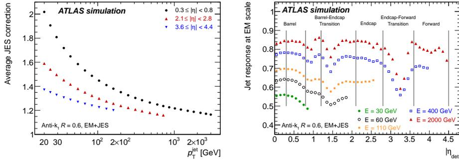
FIGURE 3.14: A gauche : correction moyenne JES en fonction du moment transverse du jet à étalonner pour des jets reconstruits par l'algorithme Anti- $k_t$  avec  $R = 0.6$  pour différente région en pseudo-rapidité. A droite : distribution de la réponse en énergie  $\mathcal{R}_{EM}^{jet}$  en fonction de la pseudo-rapidité.
