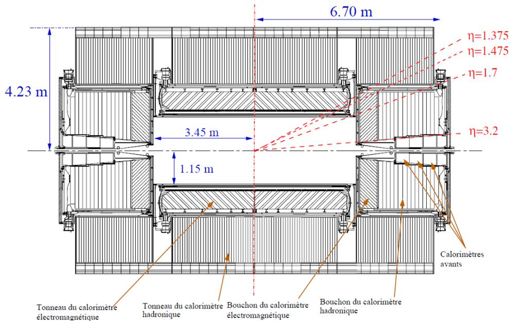
FIGURE 2.12: Schéma du système de calorimétrie d'ATLAS.
