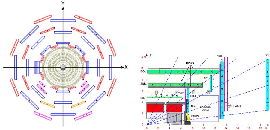
FIGURE 2.15: Géométrie du spectromètre à muon dans le détecteur ATLAS. À gauche une coupe transverse montrant les différentes couches de MDT. À droite une coupe longitudinale montrant la disposition suivant  $\eta$  de tous les sous-détecteurs.
