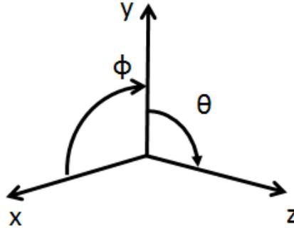
FIGURE 2.6: Coordonnées couramment utilisées dans l'expérience ATLAS. L'axe  $z$  est l'axe de propagation du faisceau, le plan  $(x,z)$  est parallèle au sol et  $y$  pointe vers le haut de la caverne d'ATLAS.
