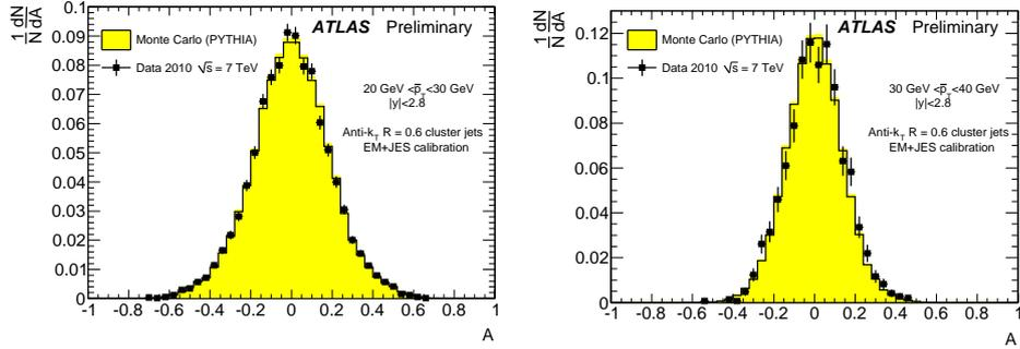
FIGURE 3.16: Comparaison de l'asymétrie  $A$  mesurée dans les données en noires et dans la simulation en jaune pour des jets reconstruit par l'algorithme Anti- $k_t$  avec  $R = 0.6$ . A gauche : pour des jets d'impulsion comprise entre 20 et 30 GeV et  $|\eta| < 2.8$ ; à droite : pour des jets d'impulsion comprise entre 30 et 40 GeV et  $|\eta| < 2.8$ .
