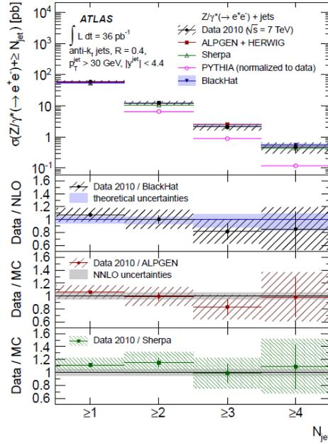
FIGURE 4.4: Comparaison entre les mesures expérimentales d'ATLAS et les prédictions de différents générateurs / modèles de gerbe hadronique pour la multiplicité en jets des événements  $Z \rightarrow ee + X$ . En abscisse est représenté la mesure de section efficace fois le rapport de branchement pour chaque multiplicité en jet.
