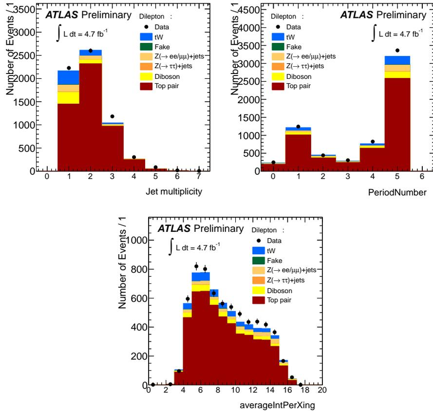
FIGURE 6.2: En haut à gauche : Distribution de la multiplicité en jet dans la simulation comparées aux données pour tous les états finaux ( $ee, \mu\mu, e\mu$ ) fusionnés. En haut à droite : Nombre d'événements sélectionnés en fonction des périodes de prises de données de 2011. En bas : Nombre moyen d'interaction par croisement de faisceau dans les données en points noirs et dans la simulation.
