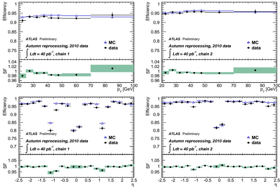
FIGURE 3.12: Comparaison des efficacités de reconstruction des muons et des facteurs correctifs extraits en fonction de  $p_T$  (ligne du haut) et en fonction de  $\eta$  (ligne du bas). Les deux colonnes représentent la chaîne 1 de reconstruction (à gauche) et la chaîne 2 (à droite). Les points noirs sont les valeurs mesurées dans les données tandis que les triangles bleus correspondent aux simulations des événements  $Z \rightarrow \mu^+ \mu^-$ .
