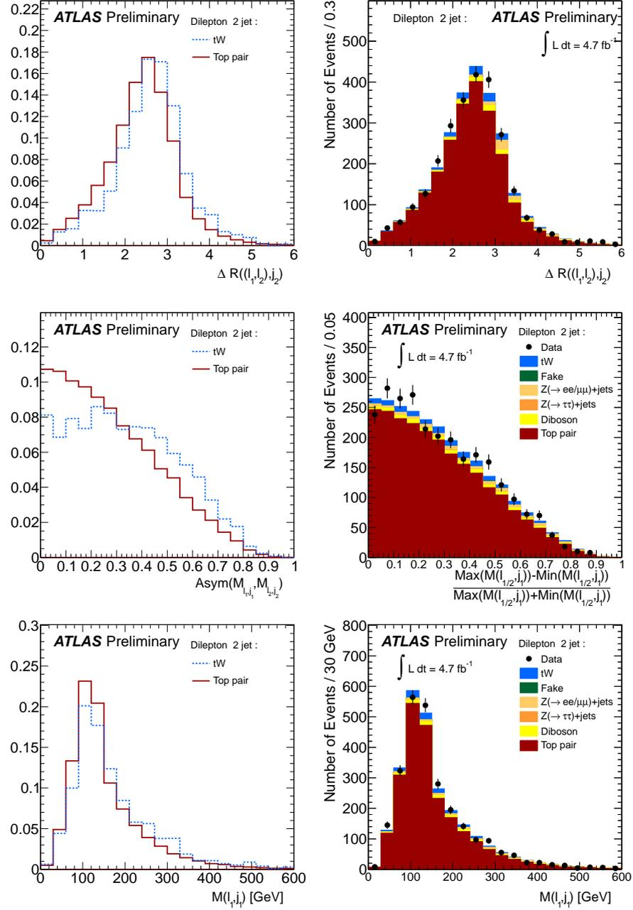
FIGURE 6.11: Distribution (de haut en bas) de  $\Delta R[(l_1, l_2), j_2]$ ,  $Asym(m_{l_1 j_1}, m_{l_2 j_2})$ , et  $m_{l_1 j_1}$  dans les événements possédant deux jets. A gauche : distribution normalisée à l'unité est comparée entre la voie- $W+t$  en bleu et  $t\bar{t}$  en rouge. A droite : comparaison entre la simulation et les données.
