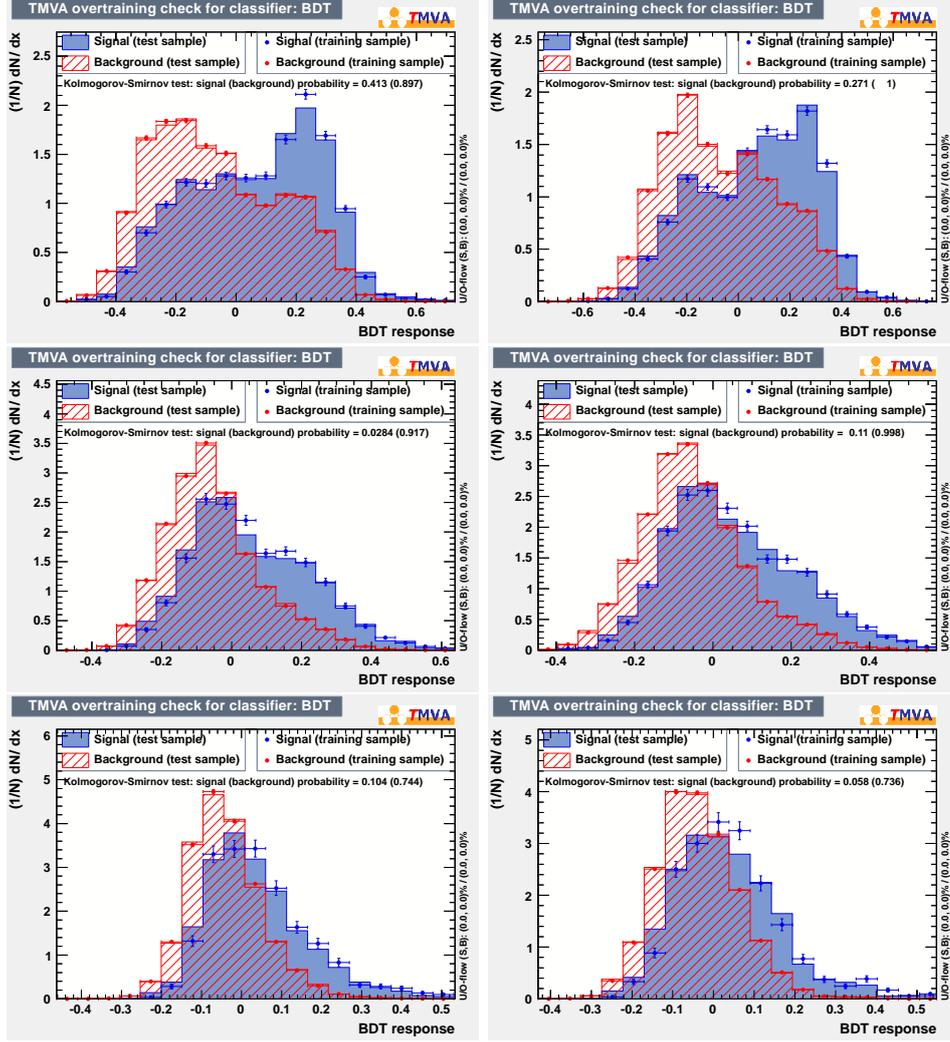
FIGURE 6.12: Distributions superposées des valeurs de sortie des BDT pour le lot d'entraînement et pour le lot de test. A gauche : pour l'état final  $e\mu$ . A droite : pour les états finaux  $ee$  et  $\mu\mu$ . De haut en bas pour les états finaux à 1, 2 et 3+ jets.
