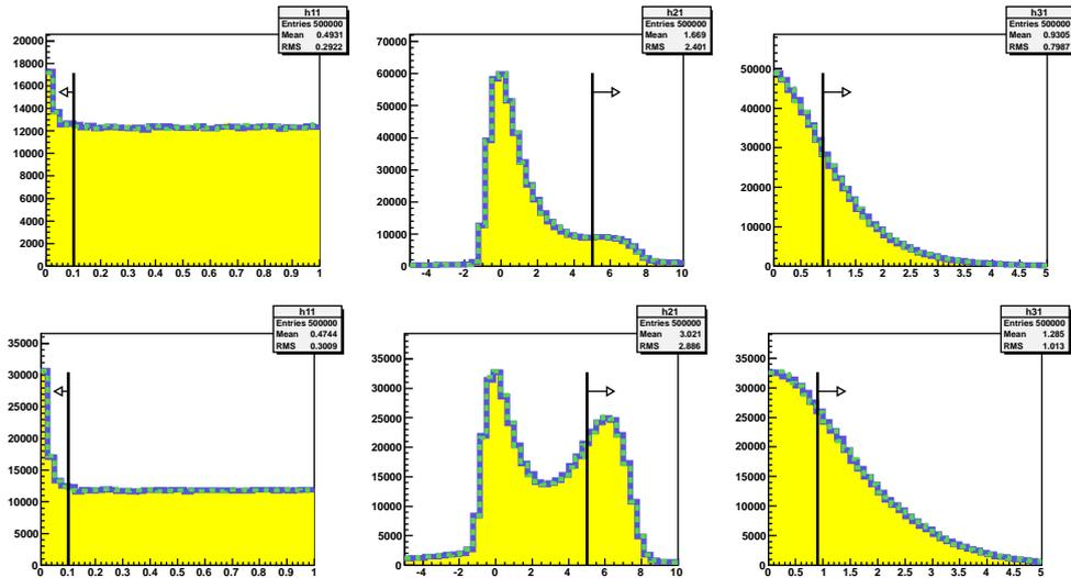
FIGURE C.2: Distribution de  $v_1$ ,  $v_2$  et  $v_3$  dans le lot de test pour  $f_a = 0.15$  (en haut) et  $f_a = 0.58$  (en bas). Les lots non corrélés sont représentés en jaune, le lot faible corrélation en ligne bleue et le lot forte corrélation en ligne verte pointillée. La flèche noire représente le critère de sélection.
