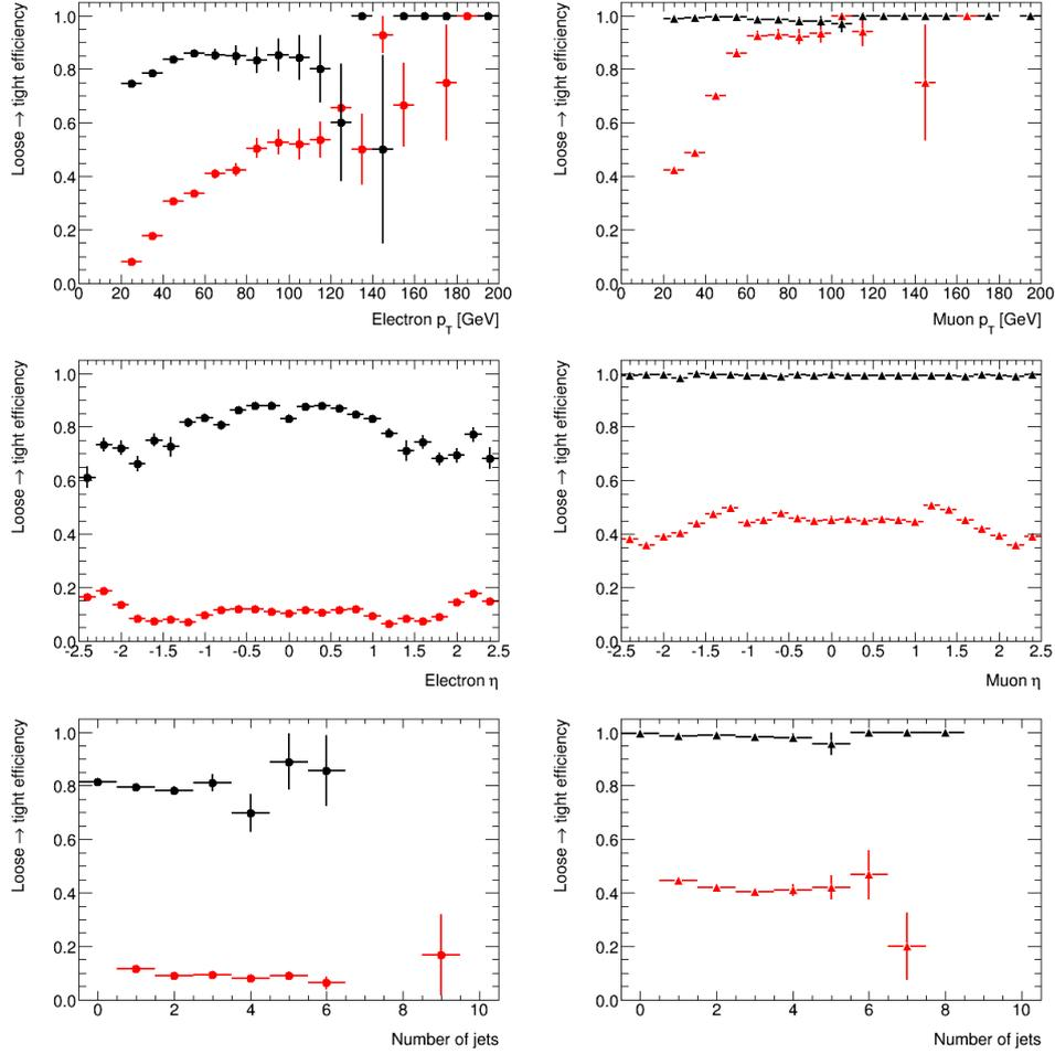
FIGURE 5.2: Paramétrisation des efficacités *loose to tight* pour les vrais leptons en noir et les faux leptons en rouge. De haut en bas : la paramétrisation en fonction du moment transverse, de la pseudo-rapidité et du nombre de jets. A gauche : électrons ; à droite : muons.
