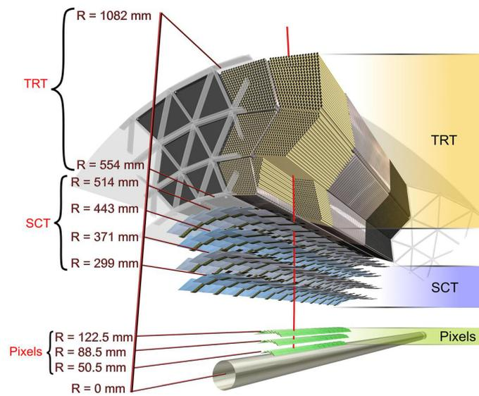
FIGURE 2.7: Vue transverse du détecteur interne d'ATLAS composé du détecteur à pixels, détecteur à micro pistes de silicium, détecteur à transition de radiation.
