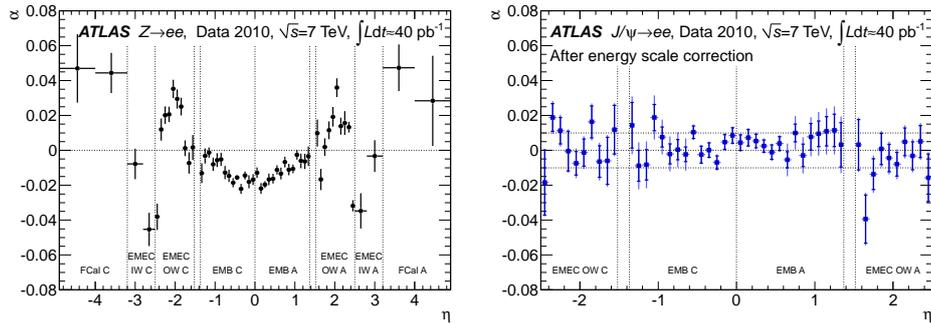
FIGURE 3.1: Valeur de la correction en énergie  $\alpha$  mesurée en fonction de la pseudo-rapidité dans les données 2010. A gauche pour le pic de masse du boson  $Z$ . A droite : pour le pic de masse du meson  $J/\psi$ .
