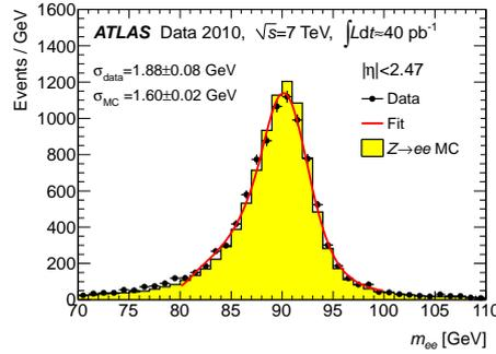
FIGURE 3.4: Mesure la correction de la résolution sur l'énergie des électrons à l'aide d'un ajustement de la masse du boson  $Z$ . En noir les points de données 2010, en jaune la simulation et trait rouge l'ajustement effectué.
