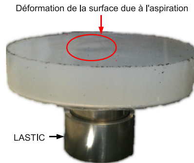
FIGURE 5.19 – Mise en évidence du décollement de la base du tissu pour l'échantillon de 15 mm d'épaisseur. L'aspiration a été faite par dessous afin de mieux visualiser.
