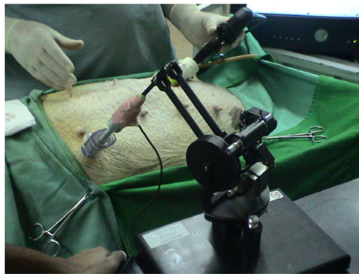
FIGURE 5.4 – Le dispositif robotique proposé par [Samur et al. 2007] utilisé dans des conditions de chirurgie mini-invasive
