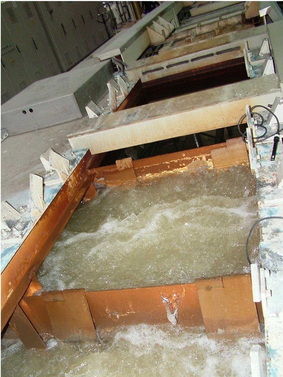
FIG. .3 – Le bain de rinçage  $B_2$  avec mélangeur en marche
