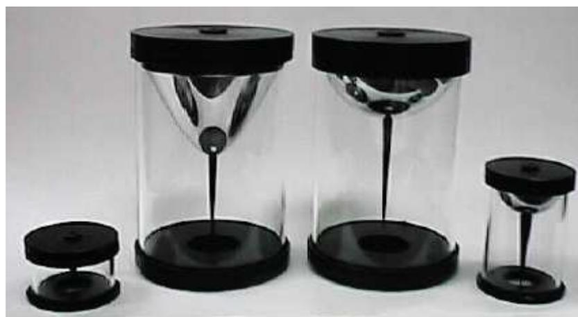
Figure II.5 : Miroirs utilisés dans des capteurs catadioptriques
