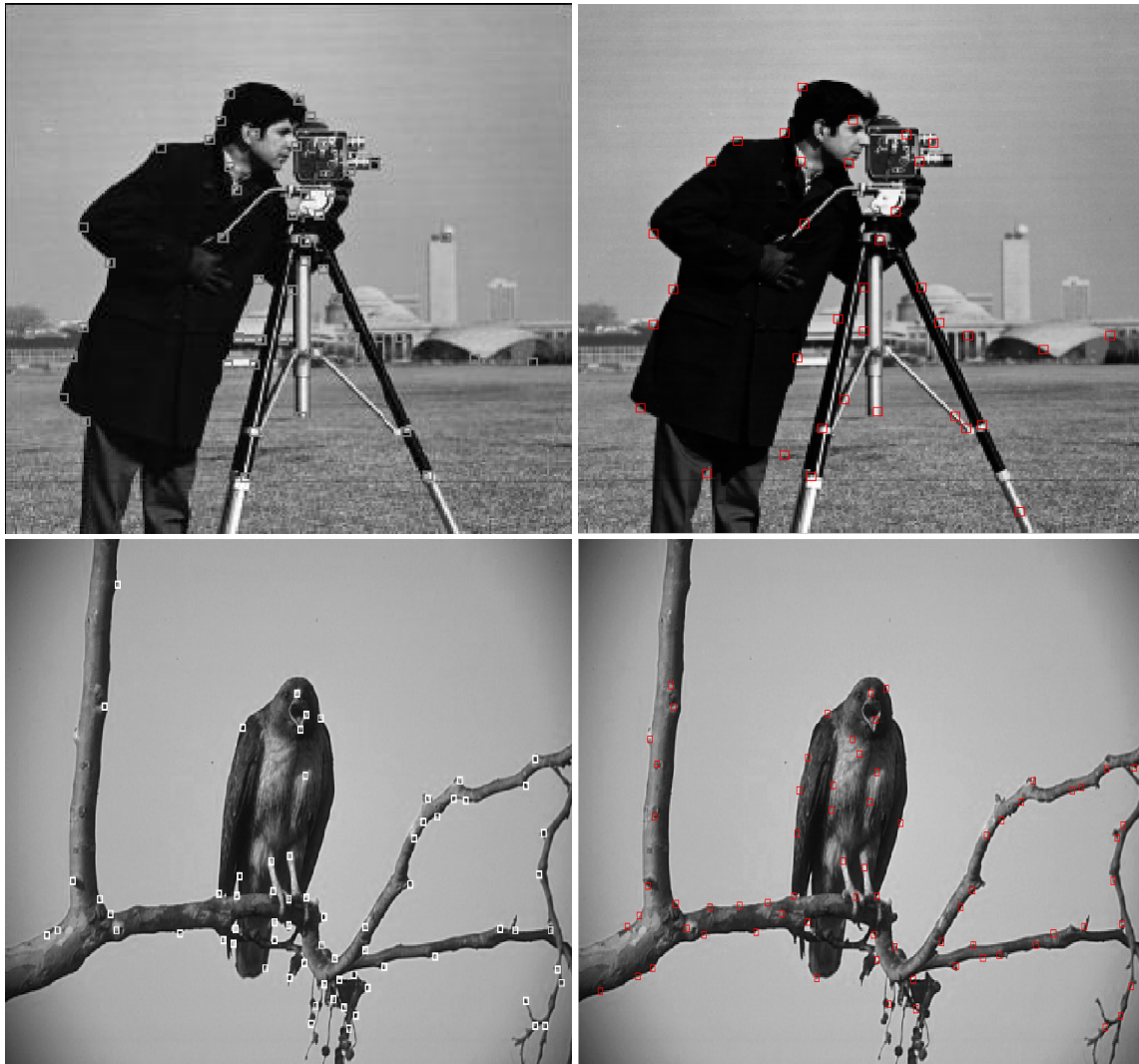
Figure V.21 : Exemples de détection de coins sur des images réelles : méthode de Harris (gauche), méthode de l'entropie (droite)
