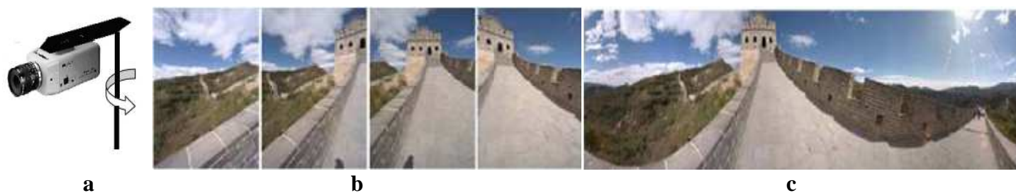
Figure II.1 : Système rotationnel : a. Caméra en rotation autour d'un axe vertical fixe, b. séquence captée, c. image panoramique reconstituée par la technique de mosaïcing
