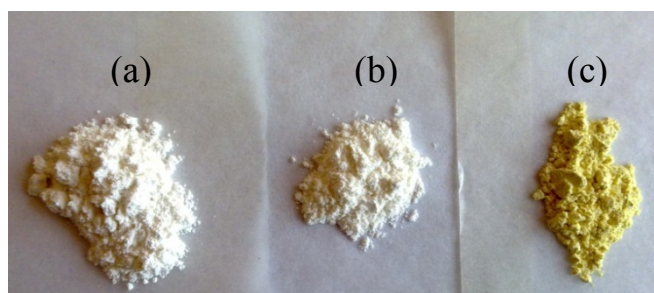
Figure 3.5 Photos de la poudre (\text{La}_{1,954}\text{Pr}_{0,006}\text{Yb}_{0,04})\text{O}_2\text{S} (a) avant sulfuration, (b) après 1h de sulfuration sous un bas débit de 90% \text{N}_2 /10% \text{H}_2\text{S} et (c) sous un haut débit de 90% \text{N}_2 /10% \text{H}_2\text{S} .
