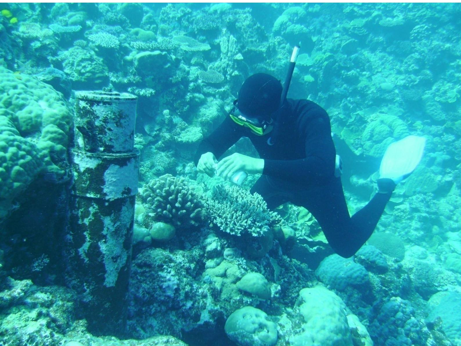
*Prélèvement d'eau de mer près du thermosalinographe (cylindre vertical) de la Fausse Passe Uitoé, Nouvelle-Calédonie. Les données SST et SSS de cet instrument ont été utilisées dans ma thèse. John Butscher, Août 2010. Crédit photo: N. Duprey.*
