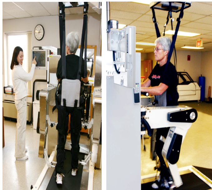
Figure II.27 : Système de rééducation AutoAmbular TM [ www.newenglandrehab.com ].
