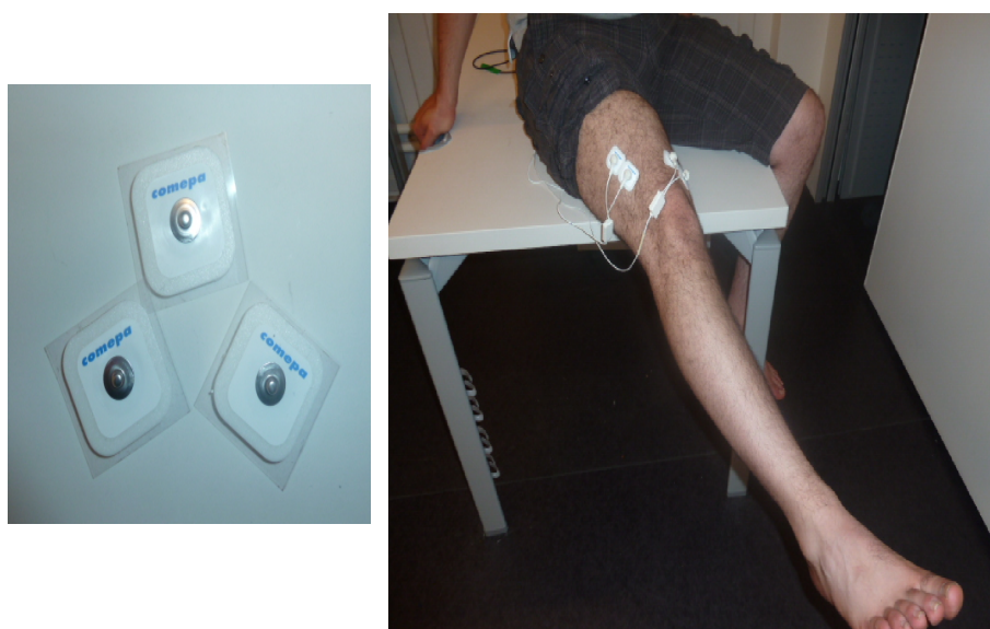
Figure III.5 : (a) Électrodes de surface EMG, (b) Exemple de placement des électrodes de surface EMG sur des muscles de la cuisse.
