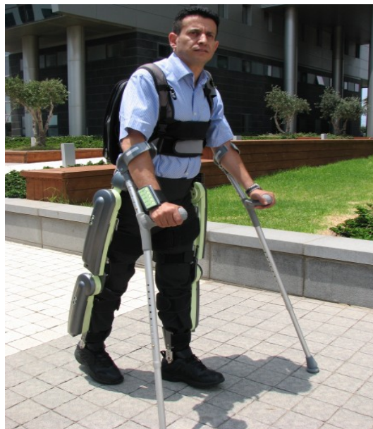
Figure II.39 : Exosquelette Rewalk conçu par la société Argo Medical Technologies [ www.technologie-innovation.fr ].
