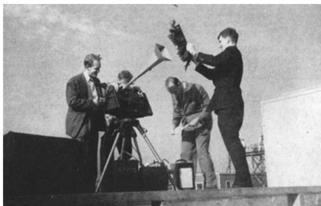
Figure 2.3: Radiomètre conçu par Dicke en 1944 - On aperçoit Dicke maintenant un absorbeur micro-onde en face de son antenne. Cet objet constituait en bonne approximation un corps noir à température ambiante à l'aide duquel ils étalonnaient leur instrument. Il est entouré de ces trois collaborateurs de l'époque : E. Beringer, R. Kyhl, et A. Vance.
