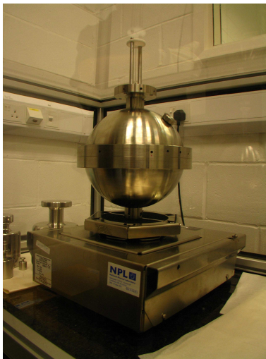
FIG. 3.8 – Photographie montrant la pesée sur un comparateur de masse Mettler Toledo AX64 . La sphère montrée est celle de l'équipe de la division thermodynamique de l'INRiM.
