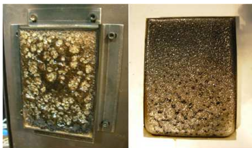
FIGURE C.3 – Comparaison de l'état de surface après combustion des deux types de plaque (PMMA A à gauche et PMMA G à droite)
