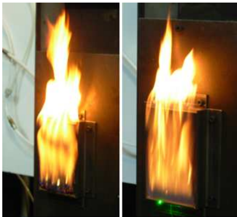
FIGURE C.2 – Comparaison des flammes obtenues avec les deux types de plaque (PMMA A à gauche et PMMA G à droite)
