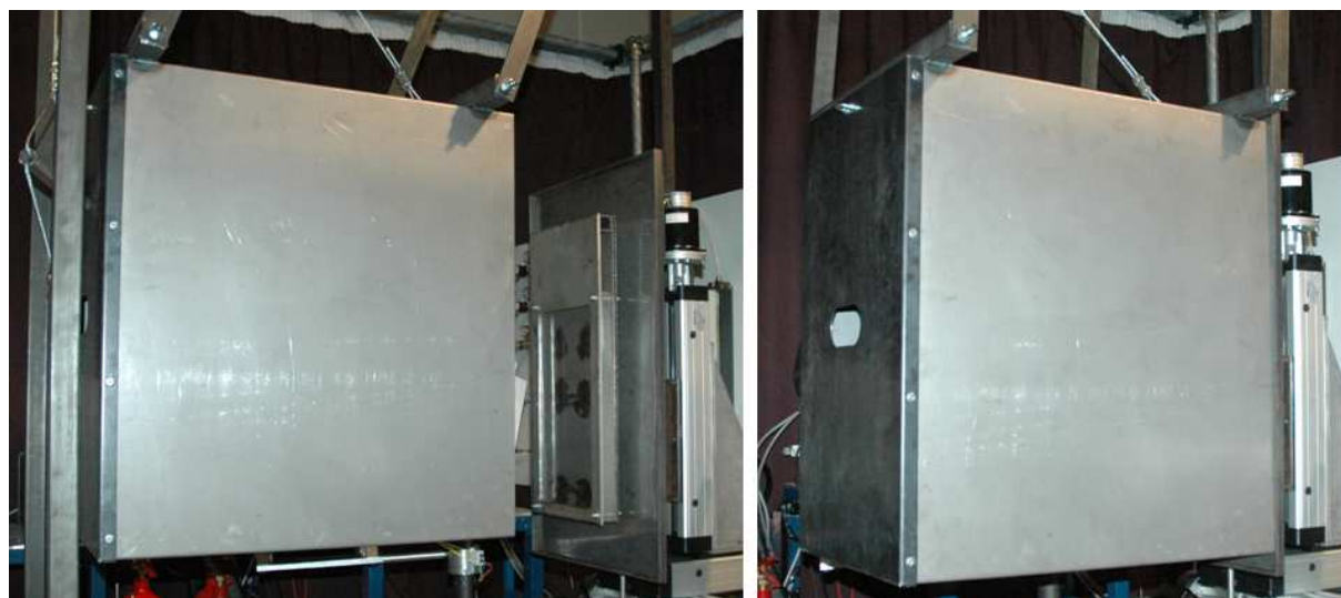
FIGURE III.5 – Système de confinement pour l’extinction de la plaque de PMMA avec un extincteur à \text{CO}_2 : position relevée pendant le déroulement des expériences (à gauche) et position abaissée pour l’extinction (à droite)
