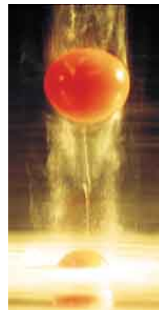
FIGURE 1.5 – Un objet en se déplaçant dans un écoulement en rotation génère une colonne de fluide parallèle à l'axe de rotation (Bush et al. , 1995).
