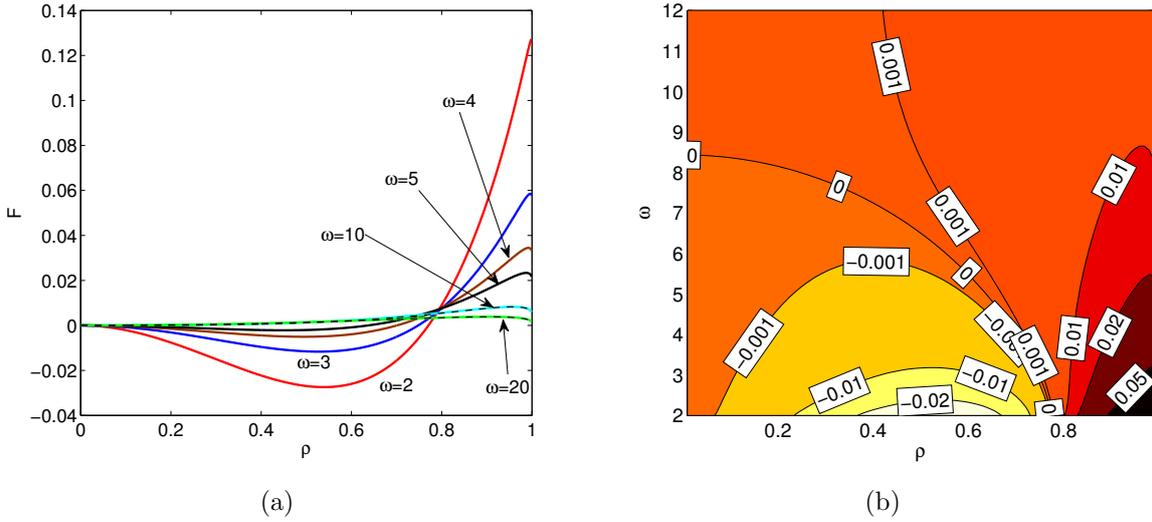
FIGURE 3.5 – (a) Représentation graphique de  $\mathcal{F}(\rho; \omega)$  en fonction de  $\rho$  pour différentes valeurs de la fréquence de libration  $\omega$ . Cette fonction caractérise  $\Psi_2$  et  $\mathcal{X}_2$  dans le volume. L’expression (3.42) est tracée en pointillés pour  $\omega = 10$  et  $\omega = 20$ . (b) Contours de la fonction  $\mathcal{F}(\rho; \omega)$  dans le plan  $(\rho, \omega)$ .
