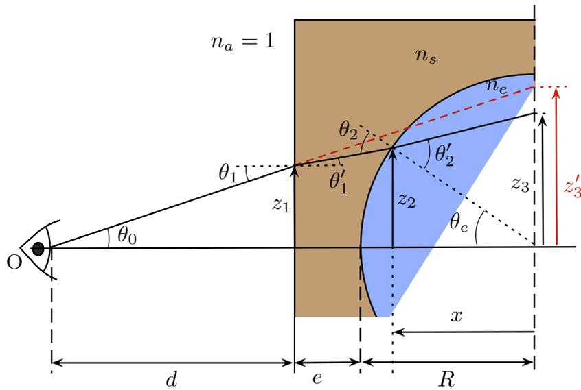
FIGURE C.4 – Représentation schématique du trajet d'un rayon lumineux dans le plan vertical à la traversée des dioptries air/silicone et silicone/eau. La caméra perçoit un pixel à une distance  $z'_3$  de l'origine alors que sa distance réelle est  $z_3$ .
