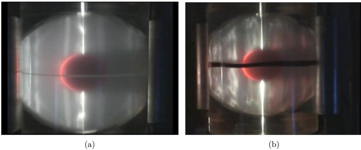
FIGURE 7.22 – Visualisation par particules de Kalliroscope de l'écoulement dans la coquille sphérique pour  $E = 1.42 \times 10^{-5}$ ,  $\Omega_R = 0,39$  et (a)  $\beta = 0,03$  et (b)  $\beta = 0,05$ .
