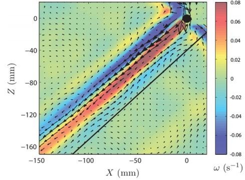
FIGURE 1.6 – Visualisation expérimentale du champ de vitesses (flèches) et de vorticité (échelle de couleurs) de l'onde inertielle générée par l'oscillation d'un cylindre. (extrait de Cortet *et al.* (2010)).
