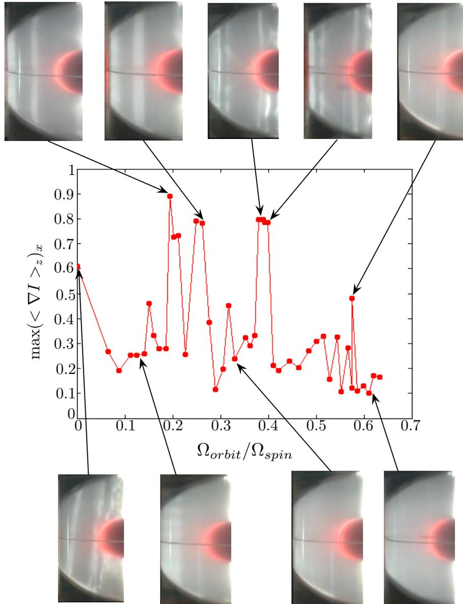
FIGURE 7.20 – Détermination des modes résonants par visualisation directe (particules de Kalliroscope) pour  $E = 9,46 \times 10^{-6}$ ,  $\beta = 0,04$ . La courbe représente le gradient d'intensité lumineuse en fonction de  $\Omega_R$ .
