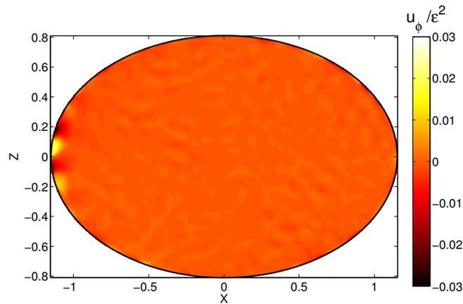
FIGURE 4.24 – Vitesse azimutale normalisée par  $\varepsilon^2$  obtenue numériquement dans le plan équatorial ( $z = 0$ ) pour des conditions aux limites de non-glissement à la paroi extérieure et pour  $\omega = 2,1$ ,  $E = 5 \times 10^{-4}$ ,  $\varepsilon = 0,4$ ,  $\beta = 0,34$  et  $c^* = 1$ .
