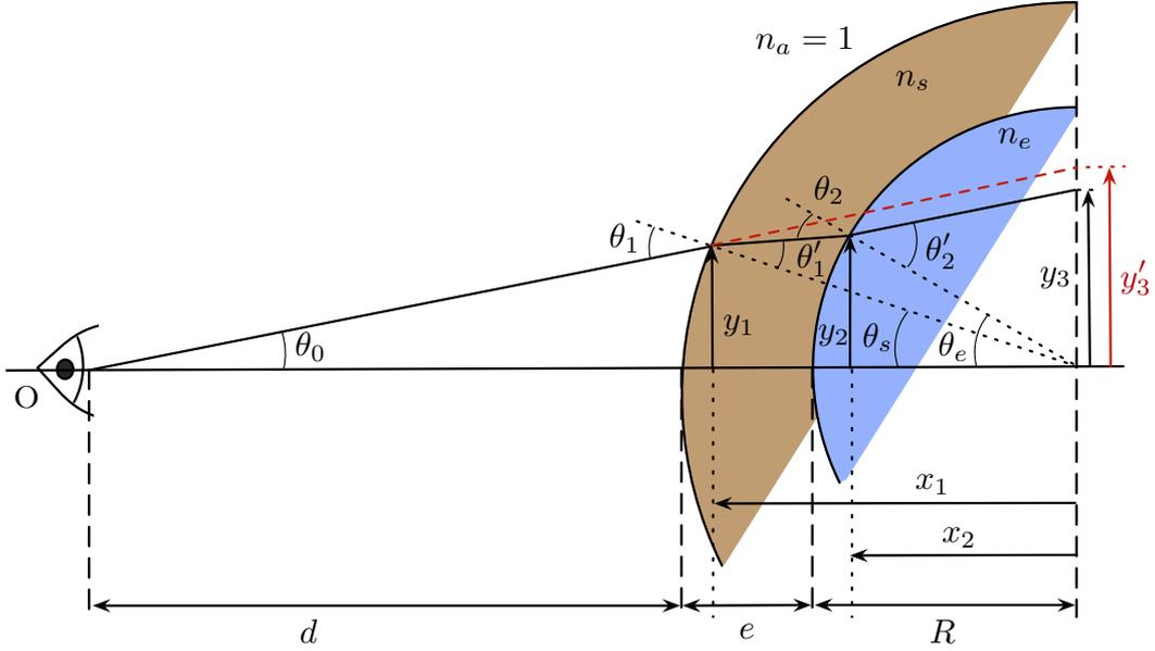
FIGURE C.2 – Représentation schématique du trajet d'un rayon lumineux à la traversée des deux dioptries cylindriques air/silicone et silicone/eau. La caméra perçoit un pixel à une distance  $y'_3$  de l'axe alors que sa distance réelle est  $y_3$ .
