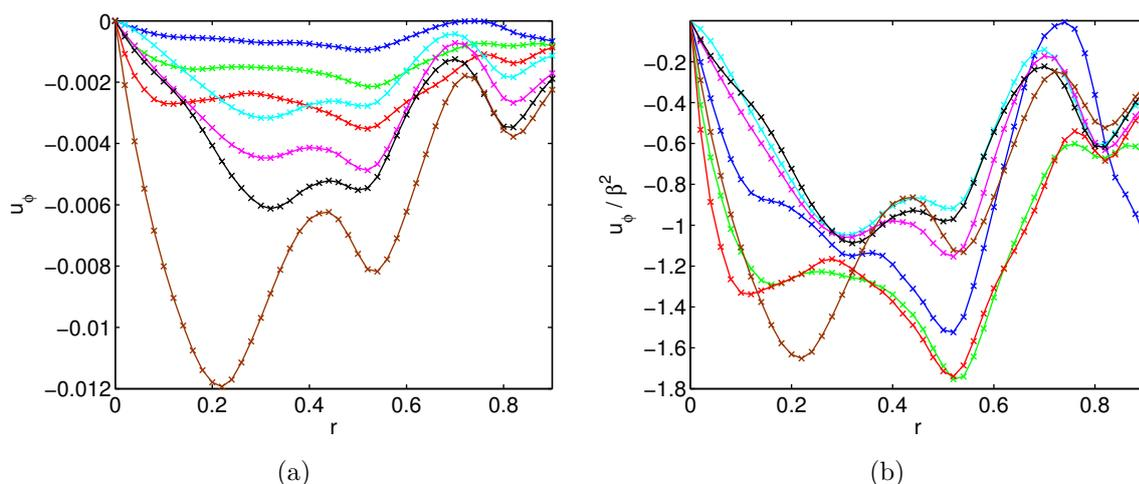
FIGURE 7.10 – (a) Vitesse azimutale de l'écoulement zonal adimensionnée,  $u_\phi$ , pour  $E = 9,46 \times 10^{-6}$ ,  $\Omega_R = 0,384$  et différentes excentricités :  $\beta = 0,025$  (bleu),  $\beta = 0,035$  (vert),  $\beta = 0,045$  (rouge),  $\beta = 0,055$  (cyan),  $\beta = 0,065$  (magenta),  $\beta = 0,075$  (noir),  $\beta = 0,085$  (marron). (b) Mêmes profils de vitesse mais renormalisés par  $\beta^2$ .
