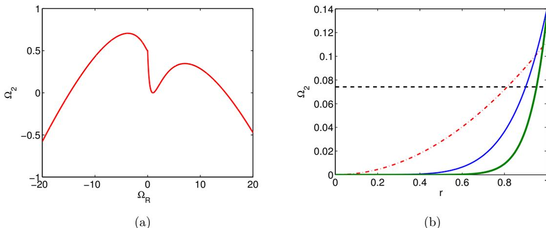
FIGURE B.2 – (a) Vitesse angulaire associée au vent zonal généré par un forçage elliptique,  $n = 2$ . (b) Vitesse angulaire associée au vent zonal généré par différents forçages multipolaires pour  $\Omega_R = 2$ ;  $n = 2$  : pointillés noirs;  $n = 3$  tirets-pointillés rouges;  $n = 5$  : courbe bleue;  $n = 8$  : courbe verte épaisse.
