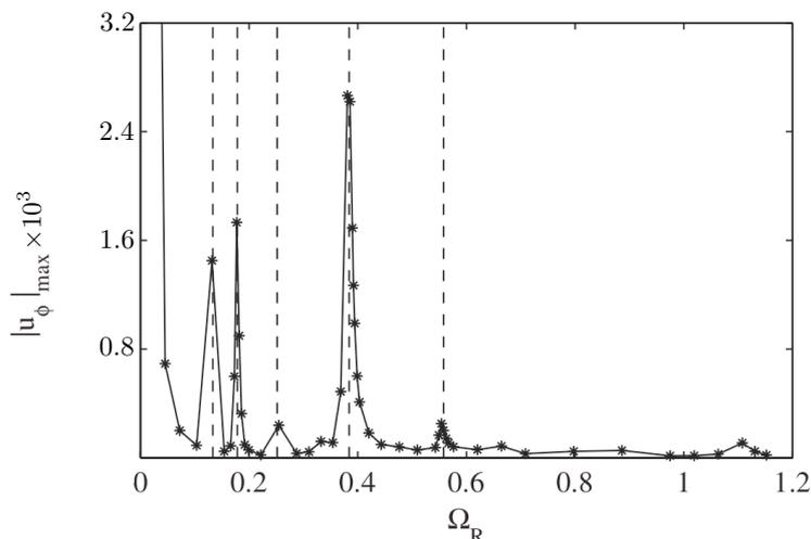
FIGURE 7.7 – Maximum de la norme de la vitesse azimutale du vent zonal adimensionnée,  $|u_\phi|_{max}$  pour  $\beta = 0,04$  et  $E = 9,46 \times 10^{-6}$  en fonction de  $\Omega_R$ . Les lignes verticales en pointillés représentent des fréquences de résonance de modes  $m = 2$  dans une sphère (extrait de [Morize et al. \(2010\)](#)).
