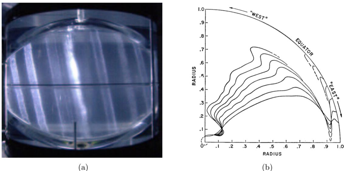
FIGURE 1.23 – (a) Visualisation des cylindres géostrophiques à l'aide de Kalliroscope dans un sphéroïde d'ellipticité 1/25 (extrait de la thèse de [Noir, 2000](#)). (b) Mesure de la dérive de colorants advectés par l'écoulement secondaire géostrophique en régime laminaire (extrait de [Malkus, 1968](#)).
