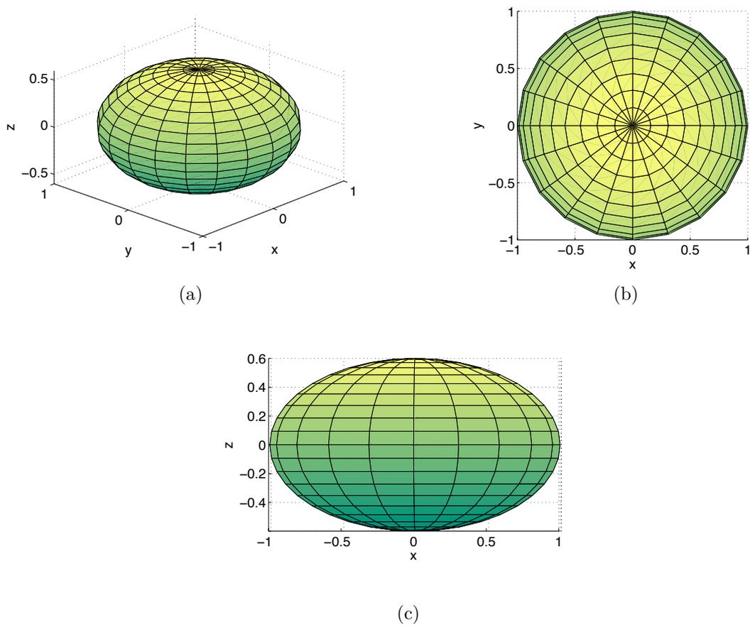
FIGURE 4.9 – (a) Sphéroïde oblate d’axe  $a = b = 1$  et  $c = 0,6$ . (b) Vue suivant l’axe de rotation mettant en évidence l’axisymétrie. (c) Vue de coté illustrant l’aplatissement du sphéroïde. L’axe de rotation est suivant  $(Oz)$ .
