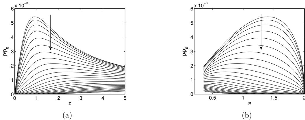
FIGURE 6.11 – (a) Solution analytique  $p/p_0$  en fonction de  $z$  calculée en  $x = 0.9$  à partir de l’expression (6.19) avec  $\nu = 10^{-5}$ ,  $\alpha = 0,1$ ,  $\tau = 0.1$ . (b) Amplitude relative  $p/p_0$ , pour les mêmes paramètres que (a) mais en fonction de la fréquence  $\omega$ . Les courbes sont tracées tous les  $\Delta t = 0,01$  et les flèches indiquent la direction du temps.
