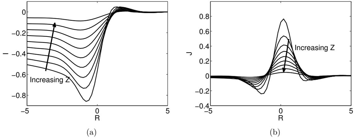
FIGURE 3.8 – Représentation graphique des fonctions (a)  $\mathbf{I}(Z,R)$  et (b)  $\mathbf{J}(Z,R)$  en fonction de  $R$  pour différentes valeurs de  $Z$  ( $Z = 0.1 : 0.1 : 0.9$ ). Ces deux fonctions caractérisent respectivement la variation spatiale dans la couche intérieure de  $\Psi_2$  et  $u_{z_2}$ .
