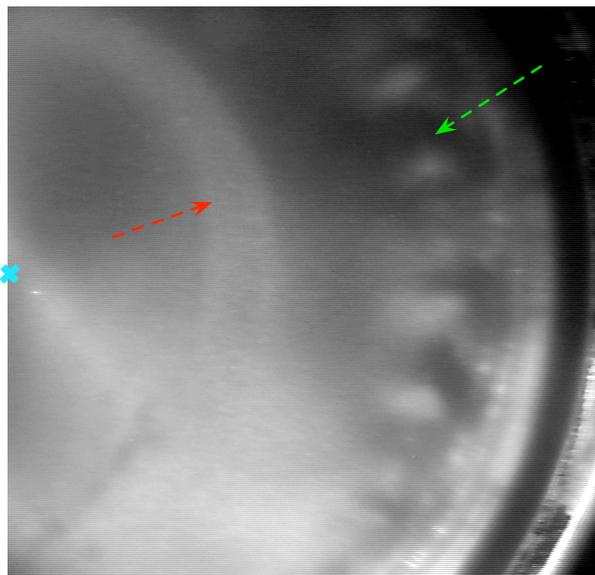
FIGURE 7.17 – Visualisation par particules de Kalliroscope dans le plan équatorial de la sphère soumise à un forçage de marées pour  $\Omega_R = 0,384$ ,  $\beta = 0,045$  et  $E = 9,46 \times 10^{-6}$ . La visualisation est faite depuis le pôle, la croix bleue indique la position approximative du centre de la sphère. Les flèches rouge et verte représentent respectivement des zones de cisaillement stable et instable.
