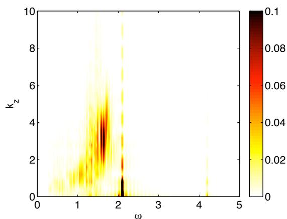
FIGURE 6.3 – Spectre spatio-temporel  $P(\omega, k_z)$  pour les mêmes paramètres que la figure 6.2 et montrant la longueur d'onde axiale et la fréquence des ondes inertielles générées. La barre de couleur représente l'amplitude de  $P(\omega, k_z)$ .
