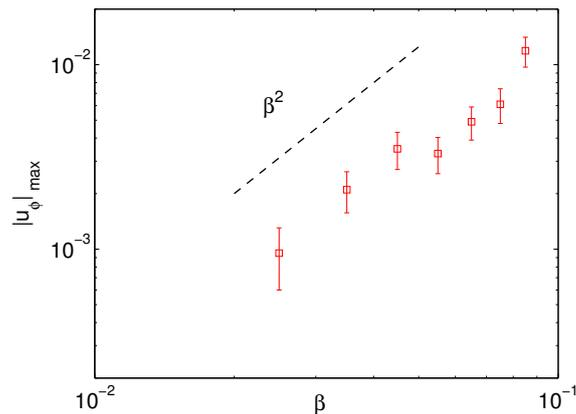
FIGURE 7.11 – Maximum de la norme de la vitesse azimutale du vent zonal adimensionnée,  $|u_\phi|_{max}$  en fonction de l'excentricité  $\beta$  pour  $E = 9,46 \times 10^{-6}$  et  $\Omega_R = 0,384$ . La droite en tirets représente une variation en  $\beta^2$ .
