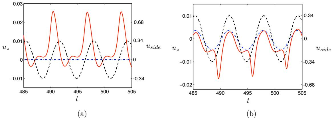
FIGURE 5.3 – Vitesse axiale,  $u_z$ , pour  $\varepsilon = 0,28$  (courbe en tirets-pointillés bleue, échelle de gauche),  $\varepsilon = 0,34$  (courbe continue rouge, échelle de gauche) et vitesse azimutale de la paroi dans le référentiel en rotation,  $u_{side}$  (courbe en tirets noire, échelle de droite) dans un cylindre de rapport d'aspect  $\alpha = 2$  et pour  $E = 4 \times 10^{-5}$  et  $\omega = 1$  (a) au point  $(r = 0,99; z = 0)$  et (b) au point  $(r = 0,99; z = 0,1)$ .
