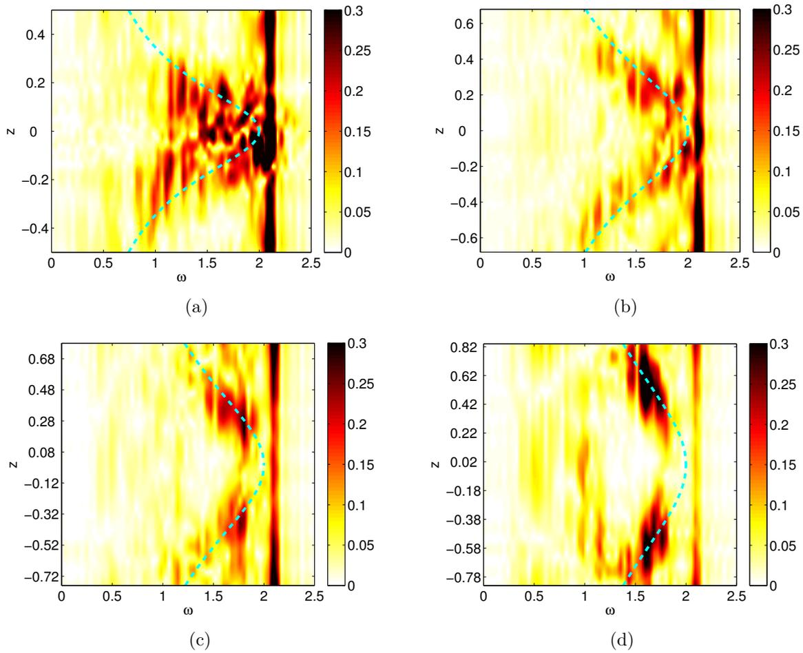
FIGURE 6.5 – Spectre temporel  $P(\omega)$  en fonction de  $z$  pour des coupes effectuées à différentes positions radiales : (a)  $r = 0,8$ , (b)  $r = 0,6$ , (c)  $r = 0,4$ , (d)  $r = 0,2$ . Les courbes en pointillés cyan représentent la position théorique d'une onde inertielle émise depuis l'équateur (formule (6.4)). Les paramètres utilisés dans la simulation sont  $\omega = 2,1$ ,  $\varepsilon = 0,7$  et  $E = 4 \cdot 10^{-5}$ .
