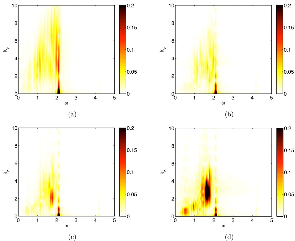
FIGURE 6.7 – Spectre spatio-temporel  $P(k_z, \omega)$  de la vitesse radiale  $u_r$  pour des coupes effectuées à différentes positions radiales : (a)  $r = 0,8$ ; (b)  $r = 0,6$ ; (c)  $r = 0,4$ ; (d)  $r = 0,2$ . Les paramètres utilisés dans cette simulation numérique sont  $E = 4 \times 10^{-5}$ ,  $\omega = 2,1$  et  $\varepsilon = 0,7$ .
