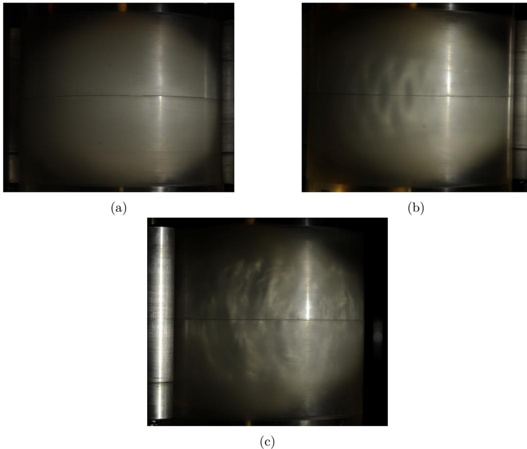
FIGURE 7.16 – Visualisation de l'écoulement en surface par particules de Kalliroscope pour  $\beta = 0,05$ ,  $E = 9,46 \times 10^{-5}$  et (a)  $\Omega_R = 0,48$  (aucun mode excité), (b)  $\Omega = 0,384$  révélant la présence d'une instabilité de longueur d'onde azimutale donnée. La figure (c) est faite pour les mêmes paramètres que (b) mais avec une amplitude de forçage plus grande,  $\beta = 0,075$  illustrant la présence d'un écoulement turbulent.
