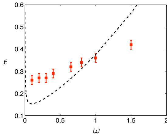
FIGURE 5.8 – Diagramme de stabilité d’apparition des rouleaux de Taylor-Görtler en fonction de la fréquence de libration longitudinale  $\omega$ . Les carrés indiquent le seuil obtenu numériquement pour  $E = 6 \times 10^{-5}$  dans un cylindre de rapport d’aspect  $\alpha = 2$ . La courbe en pointillés est le critère de stabilité visqueux (5.20) sans aucun paramètre d’ajustement.
