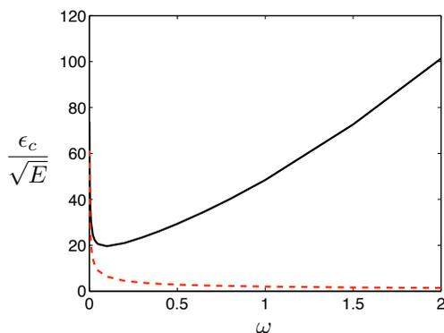
FIGURE 5.4 – Amplitude critique  $\varepsilon_c/\sqrt{E}$  d'apparition de l'instabilité centrifuge obtenue théoriquement. La courbe continue noire est le critère visqueux  $\varepsilon_c^{(V)}(\omega)/\sqrt{E}$  (relation (5.20)) et la courbe rouge en pointillés est le critère non-visqueux  $\varepsilon_c^{(NV)}(\omega)/\sqrt{E} = 2/\sqrt{\omega}$  (relation (5.8)).
