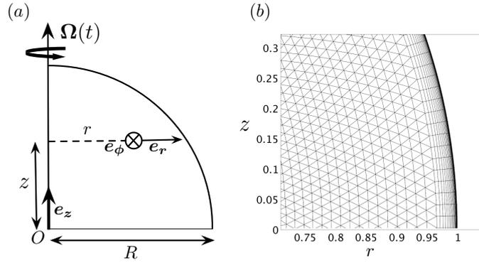
FIGURE 2.8 – (a) Schéma du quart supérieur de la sphère et des coordonnées cylindrico-polaires  $(\mathbf{e}_r, \mathbf{e}_\phi, \mathbf{e}_z)$ . (b) Zoom sur le maillage utilisé dans le modèle numérique montrant deux zones : une zone en volume avec des éléments triangulaires et une zone de couche visqueuse avec des éléments quadrilatéraux
