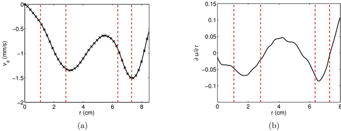
FIGURE C.7 – (a) Vitesse azimutale et (b) gradient radial de la vitesse azimutale  $\partial u_\phi / \partial r$  correspondant au champ PIV présenté figure C.7(b). Les courbes rouges en pointillés représentent la position des bandes lumineuses observées avec les particules de Kalliroscope.
