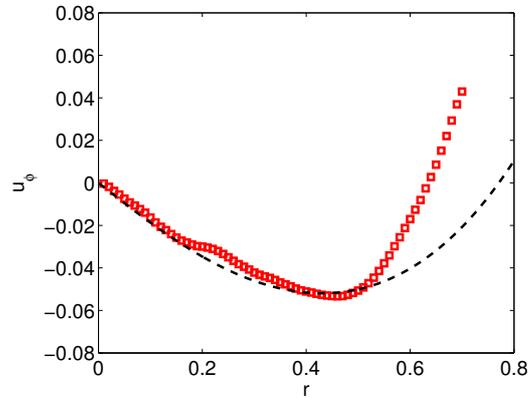
FIGURE 4.23 – Champ des vitesses obtenue numériquement pour  $\omega = 2,1$ ,  $E = 5 \times 10^{-4}$ ,  $\varepsilon = 0,4$ ,  $\beta = 0,34$  et  $c^* = 1$  moyenné en temps et en azimut sur  $\theta$  (carrés rouges). Courbe théorique correspondant aux mêmes paramètres dans une sphère en libration obtenue par la formule (A.14) donnée en annexe A
