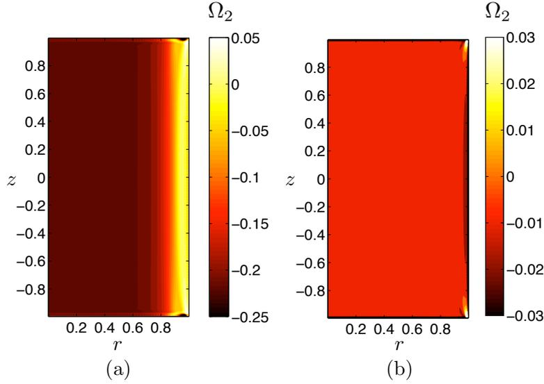
FIGURE 4.12 – Vitesse angulaire  $\Omega_2 = u_{\theta,2}/r$  du vent zonal dans un cylindre de rapport d’aspect  $\alpha = 2$  obtenue numériquement pour  $\varepsilon = 0,05$ ,  $E = 4 \times 10^{-5}$ , (a)  $\omega = 0,05$  et (b)  $\omega = 6$ .
