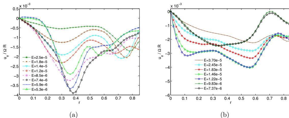
FIGURE 7.13 – Vitesse azimutale du vent zonal adimensionnée,  $u_\phi$ , pour  $\beta = 0,045$ , et différents nombres d’Ekman (indiqués sur la figure) pour le mode correspondant à (a)  $\Omega_R = 0,178$  et (b)  $\Omega_R = 0,384$ .
