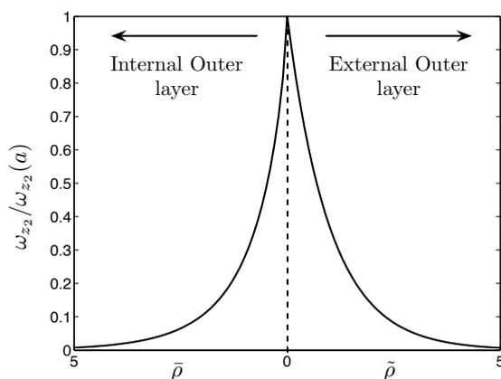
FIGURE 3.7 – Vorticité axiale  $\omega_{z_2}/\omega_{z_2}(a)$  en fonction de  $\bar{\rho} = (a - \rho) [a/(2E^2)/(1 - a^2)^2]^{1/7}$  pour  $\rho < a$  (couche externe à gauche), et  $\tilde{\rho} = (\rho - a)/[(1 - a^2)^{3/8} E^{1/4}]$  pour  $\rho > a$  (couche externe à droite).
