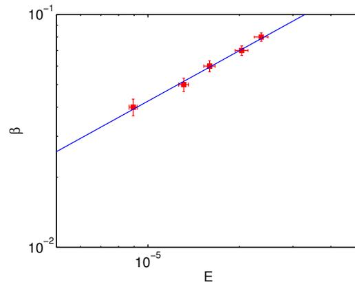
FIGURE 7.19 – Seuil de stabilité obtenu expérimentalement pour la bande interne du mode à  $\Omega_R = 0,38$  (carrés rouges). La droite bleue est la loi d'échelle obtenue à la relation 7.8 avec un préfacteur :  $\beta_c = 167,3 E^{0,72}$ .
