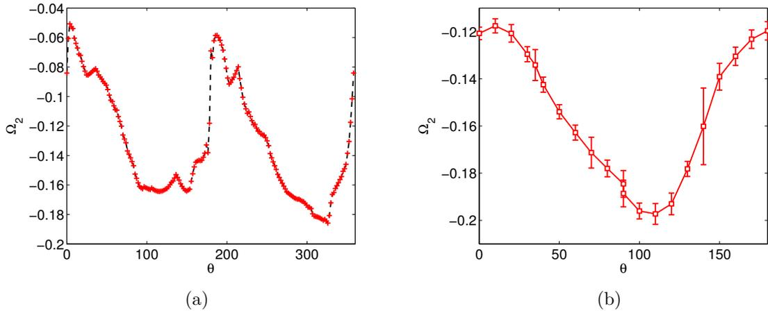
FIGURE 4.22 – (a) Vitesse moyennée dans le temps au point  $r = 0,38$  obtenue numériquement pour  $\omega = 2,1$ ,  $E = 5 \times 10^{-4}$ ,  $\varepsilon = 0,4$ ,  $\beta = 0,34$  et  $c^* = 1$  en fonction de l'angle  $\theta$ . (b) Vitesse moyennée dans le temps au point  $r = 0,38$  obtenue expérimentalement pour  $E = 2 \times 10^{-5}$ ,  $\omega = 1$ ,  $\varepsilon = 0,61$  au point  $r = 0,38$  (résultat expérimental de J. Noir).
