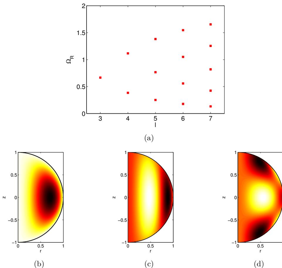
FIGURE 7.5 – (a) Valeurs de  $\Omega_R$  associées aux modes propres de la sphère soumise à un forçage  $m = 2$  en fonction du degré du polynôme de Legendre  $l$ . Champ de pression associé au mode propre (b)  $\Omega_R = 0,3841$  ( $l = 4$ ), (c)  $\Omega_R = 0,1782$  ( $l = 6$ ) et (d)  $\Omega_R = 0,5578$  ( $l = 6$ ) dans une sphère en rotation soumise à un forçage de marées ( $m = 2$ ).
