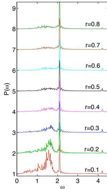
FIGURE 6.6 – Moyenne axiale du spectre temporel de la vitesse radiale  $u_r$  pour  $\varepsilon = 0,8$ ,  $\omega = 2,1$  et  $E = 4 \times 10^{-5}$  mesurée en 8 rayons équidistants de  $r = 0,1$  à  $r = 0,8$ .
