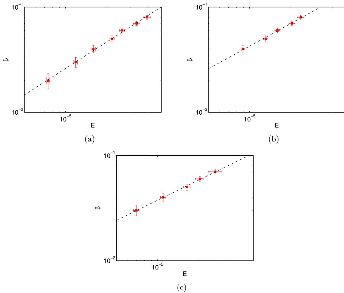
FIGURE 7.18 – Seuil de stabilité obtenu expérimentalement pour (a) la bande externe du mode à  $\Omega_R = 0,38$ , la droite en tirets noirs est la meilleure régression linéaire :  $\beta_c = 399,6 E^{0,84}$ . (b) Bande interne du mode à  $\Omega_R = 0,38$ , la droite en tirets noirs a pour équation  $\beta_c = 160,6 E^{0,715}$ . (c) Bande externe du mode à  $\Omega_R = 0,178$ , la droite en tirets noirs a pour équation  $\beta_c = 58,5 E^{0,639}$ .
