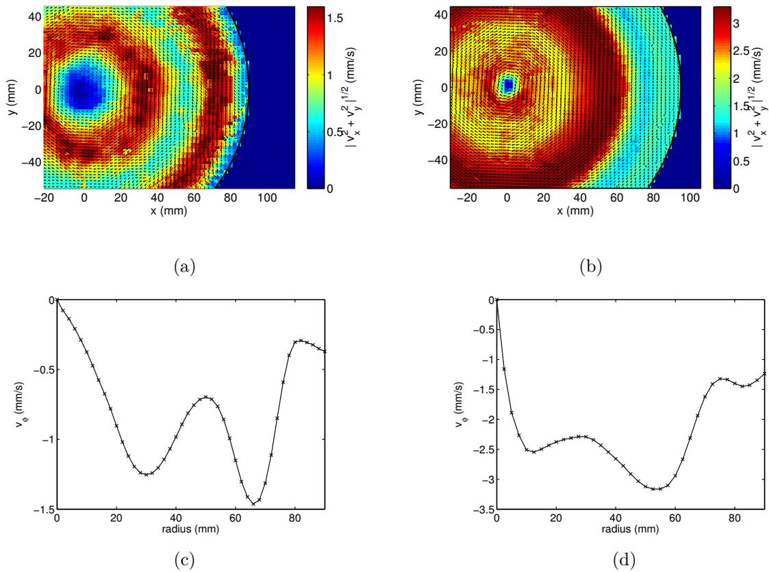
FIGURE 7.9 – Champs de vitesses obtenus par mesures PIV dans le plan équatorial pour  $\beta = 0,045$  et (a)  $E = 1,4 \times 10^{-5}$ ,  $\Omega_R = 0,178$  et (b)  $E = 1,25 \times 10^{-5}$ ,  $\Omega_R = 0,384$ . Le centre de la sphère est en  $(0,0)$ . (c) et (d) sont respectivement les profils de vitesse azimutale en fonction du rayon pour les champs PIV (a) et (b).
