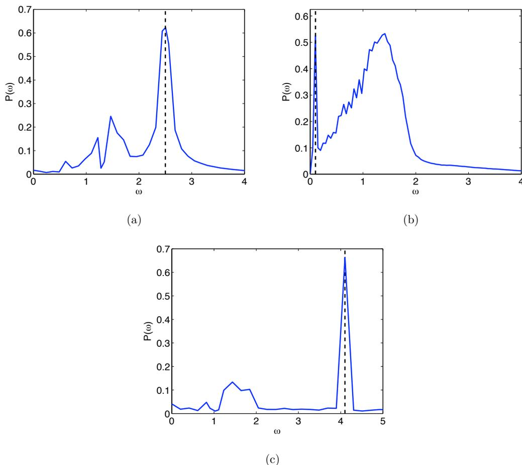
FIGURE 6.14 – Moyennes verticales des spectres temporels, pris en  $r = 0,6$  correspondant aux situations présentées dans la figure 6.12, plus précisément pour (a)  $\omega = 2,5$ , (b)  $\omega = 0,1$ , (c)  $\omega = 4,1$ . Les lignes en tirets noirs indiquent dans chaque cas la fréquence de libration.
