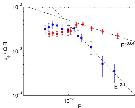
FIGURE 7.14 – Maximum de la norme de la vitesse azimutale du vent zonal adimensionnée,  $|u_\phi|_{max}$  en fonction du nombre d'Ekman  $E$  pour  $\beta = 0,045$  et  $\Omega_R = 0,178$  (cercles bleus) et  $\Omega_R = 0,384$  (cercles rouges). Les droites en pointillés représentent les meilleures régressions linéaires, respectivement de pente  $E^{-2,1}$  et  $E^{-0,64}$ .
