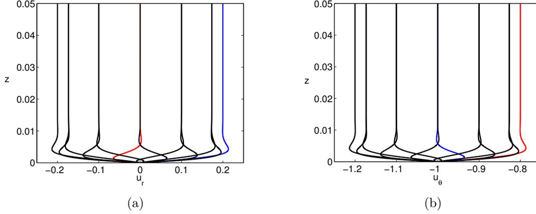
FIGURE B.1 – Champ des vitesses dans la couche limite inférieure pour une déformation elliptique,  $n = 2$ ,  $\Omega_R = 3$ ,  $\beta = 0.2$  et  $E = 10^{-5}$  (a) Vitesse radiale et (b) vitesse azimuthale dans le référentiel lié à la déformation. Douze profils régulièrement espacés entre  $\theta = 0$  et  $\theta = \pi$  sont représentés en  $r = 0.5$ . Les profils rouge et bleu correspondent respectivement à  $\theta = 0$  et  $\theta = \pi/4$ .
