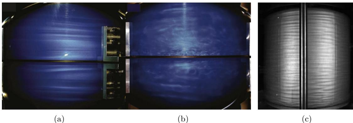
FIGURE 1.28 – (a) Instabilité induite par un forçage de libration longitudinale dans une sphère et (b) écoulement turbulent obtenu à plus grande amplitude de forçage (Noir *et al.*, 2009). (c) Même instabilité en géométrie cylindrique (Noir *et al.*, 2010).
