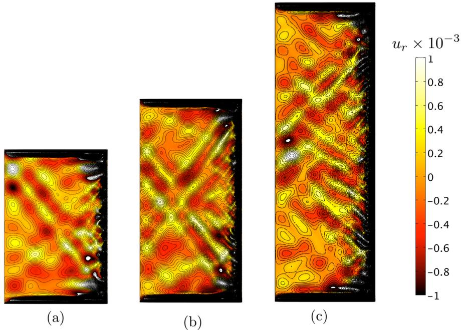
FIGURE 6.15 – Influence de la hauteur du cylindre sur la génération spontanée d’ondes inertielles. Les trois cas correspondent au même nombre d’Ekman,  $E = \nu/\Omega_R R^2 = 4 \times 10^{-5}$ ,  $\omega = 2,1$  et  $\varepsilon = 0,7$ . Seule la hauteur du cylindre change : (a)  $\alpha = H/R = 1,5$ , (b)  $\alpha = H/R = 2$  et (c)  $\alpha = H/R = 3$ .
