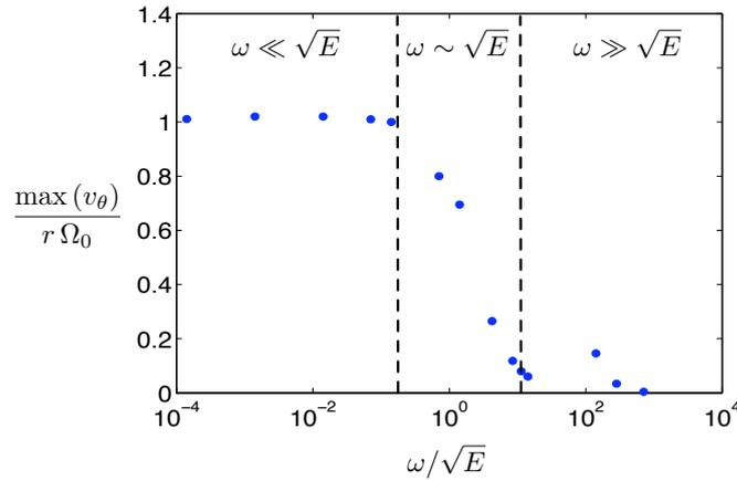
FIGURE 1.16 – Maximum de la vitesse azimutale,  $\max(v_\theta)$ , au point  $(r = 0.5; z = 0)$  dans une sphère, normalisée par la rotation solide en ce point  $r\Omega_0$  obtenu par simulation numérique (Paramètres :  $E = 5.10^{-5}$ ,  $\epsilon = 0.1$ ).
