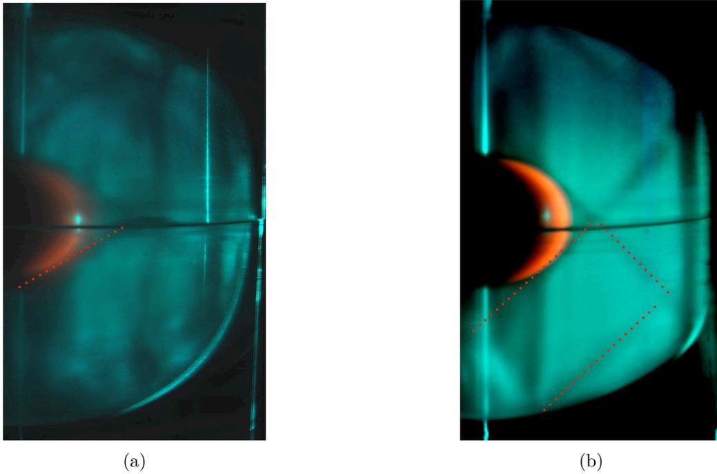
FIGURE 7.21 – Visualisation par particules de Kalliroscope de modes résonants dans la coquille sphérique pour  $E = 9.86 \times 10^{-6}$ ,  $\beta = 0,03$  et (a)  $\Omega_R = 0,191$ , (b)  $\Omega_R = 0,39$ .
