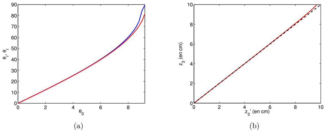
FIGURE C.5 – (a) Angle perçu par la caméra  $\theta_r$  (en rouge) et angle réel  $\theta_r$  (en bleu) tenant compte de la réfraction des rayons lumineux dans le plan vertical. (b) Distance au centre perçue par la caméra  $z_3$  en fonction de la distance réelle au centre  $z_3'$  (courbe rouge). La courbe noire en pointillés représente ces distances en l'absence de réfraction.
