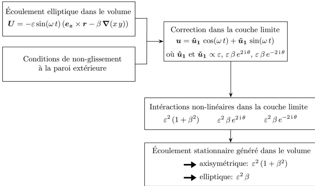
FIGURE 4.25 – Principe du calcul conduisant à l’écoulement non-linéaire stationnaire généré par un forçage de libration longitudinale dans un ellipsoïde.
