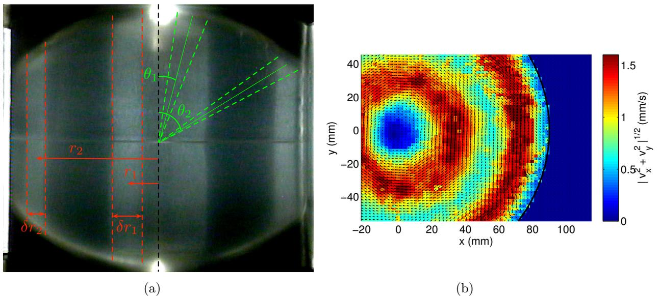
FIGURE C.6 – (a) Visualisation par particules de Kalliroscope du mode résonant obtenu avec un forçage de marées pour  $\Omega_R = 0,178$ ,  $E = 1,4 \times 10^{-5}$  et  $\epsilon = 0,04$ . (b) Champ PIV résultant pour les mêmes paramètres que la figure (a).
