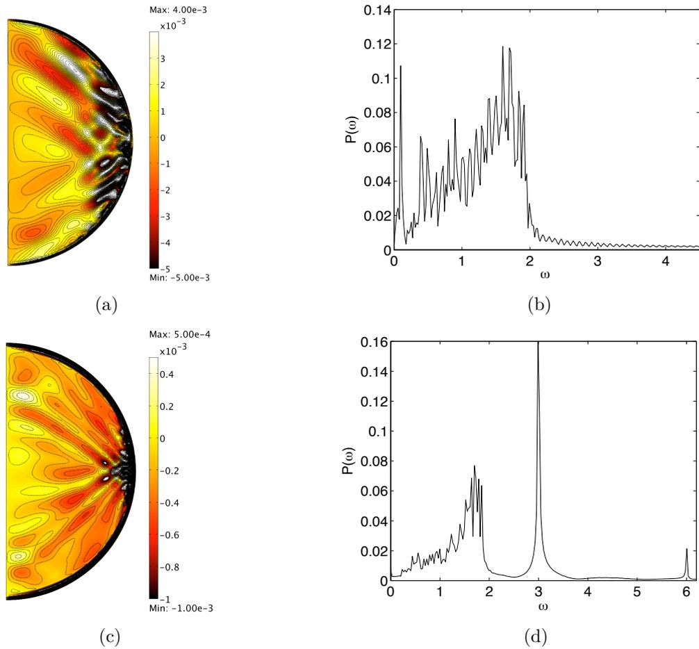
FIGURE 6.9 – Champ de vitesse radiale  $u_r$  pour  $E = 4 \times 10^{-5}$ ,  $\varepsilon = 0,8$ , (a)  $\omega = 0,1$  et (c)  $\omega = 3$ . Moyenne axiale des spectres temporels correspondant, pris en  $r = 0,2$  pour (b)  $\omega = 0,1$  et (d)  $\omega = 3$ .
