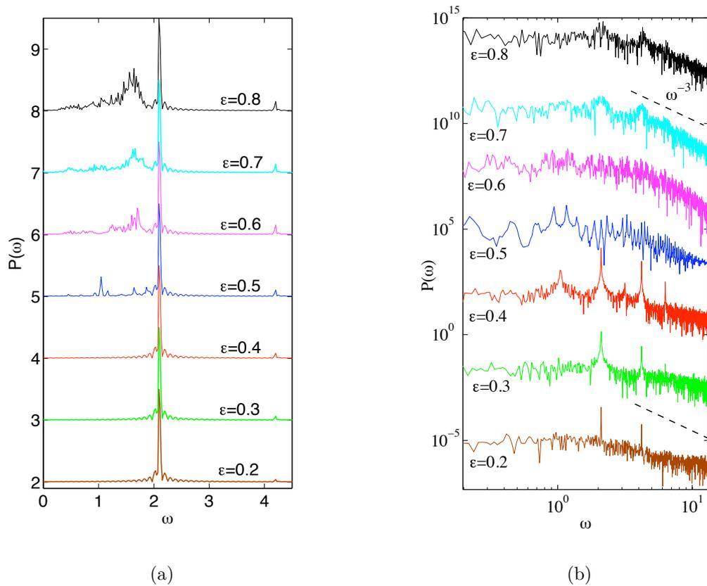
FIGURE 6.8 – (a) Moyenne axiale du spectre temporel de la vitesse radiale  $u_r$  en  $r = 0,2$  pour  $\omega = 2,1$ ,  $E = 4 \times 10^{-5}$  et différentes amplitudes de libration longitudinale  $\epsilon$ . (b) Spectre temporel de la vitesse axiale mesurée au voisinage de la paroi extérieure au point  $(r = 0,99; z = 0,1)$  pour les mêmes paramètres que la figure (a).
