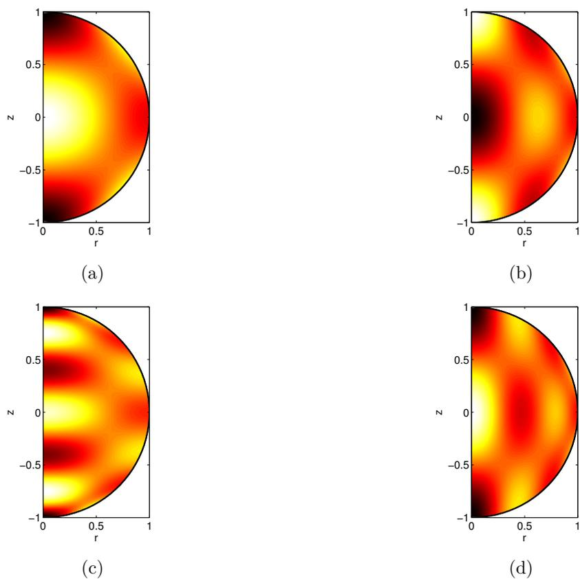
FIGURE 1.9 – Champ de pression associé aux modes propres dans une sphère en rotation soumise à un forçage de libration longitudinale ( $m = 0$ ). Solution analytique pour (a)  $\omega = 1,3089$  ( $l = 4$ ), (b)  $\omega = 0,9381$  ( $l = 6$ ), (c)  $\omega = 1,7995$  ( $l = 6$ ) et (d)  $\omega = 0,7262$  ( $l = 8$ ).
