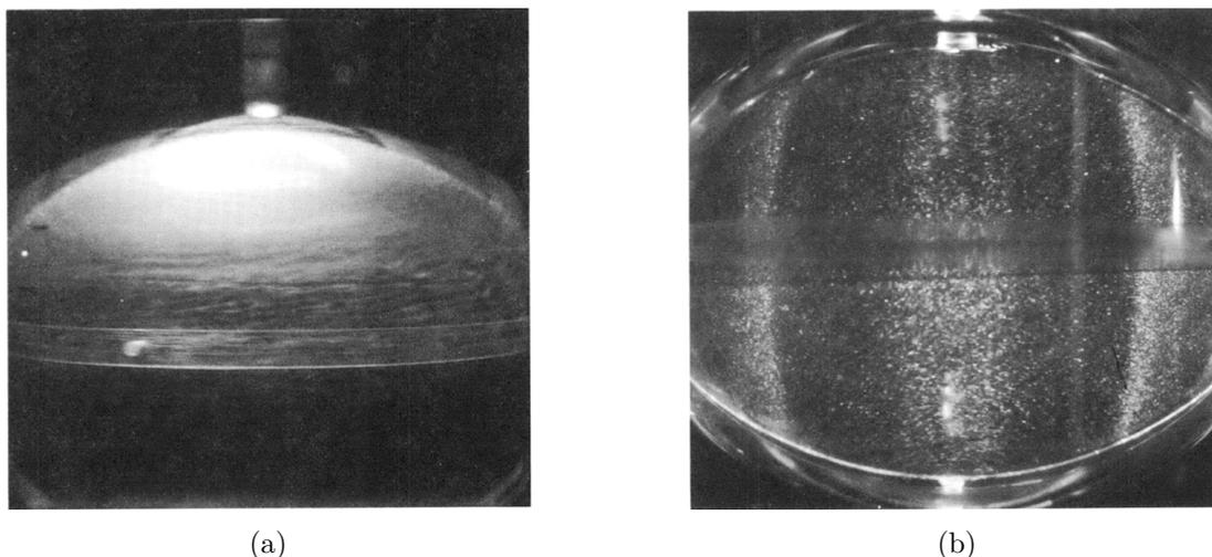
FIGURE 1.17 – (a) Visualisation des rouleaux générés par l'instabilité proche de la paroi (b) Bandes de cisaillement mettant en évidence la résonance d'un mode (extraits de Aldridge (1967)).
