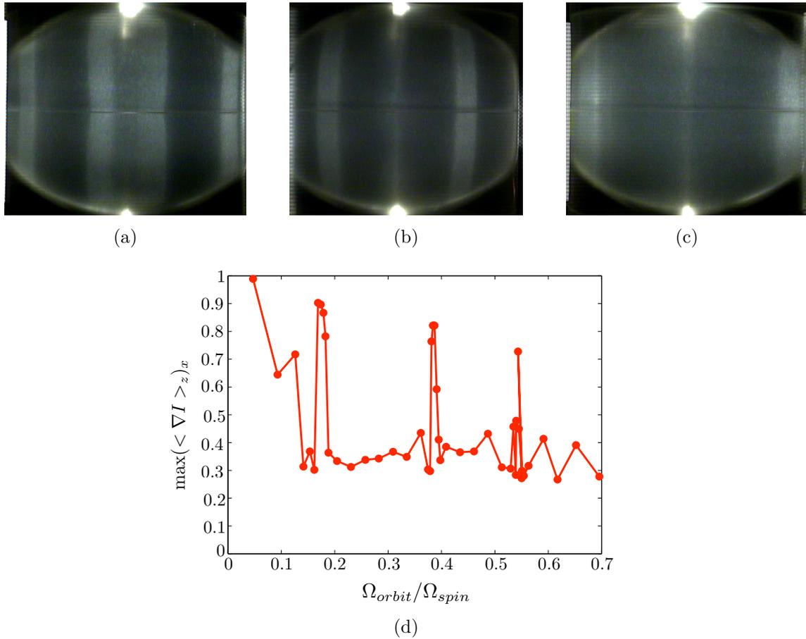
FIGURE 7.8 – Détermination des modes résonants par visualisation directe (particules de Kalliroscope) pour  $E = 1,45 \times 10^{-5}$ ,  $\beta = 0,04$  et (a)  $\Omega_R = 0,178$ , (b)  $\Omega_R = 0,384$  et (c)  $\Omega_R = 0,55$ . (d) Gradient d'intensité lumineuse en fonction de  $\Omega_R$  pour  $E = 1,45 \times 10^{-5}$  et  $\beta = 0,04$ .
