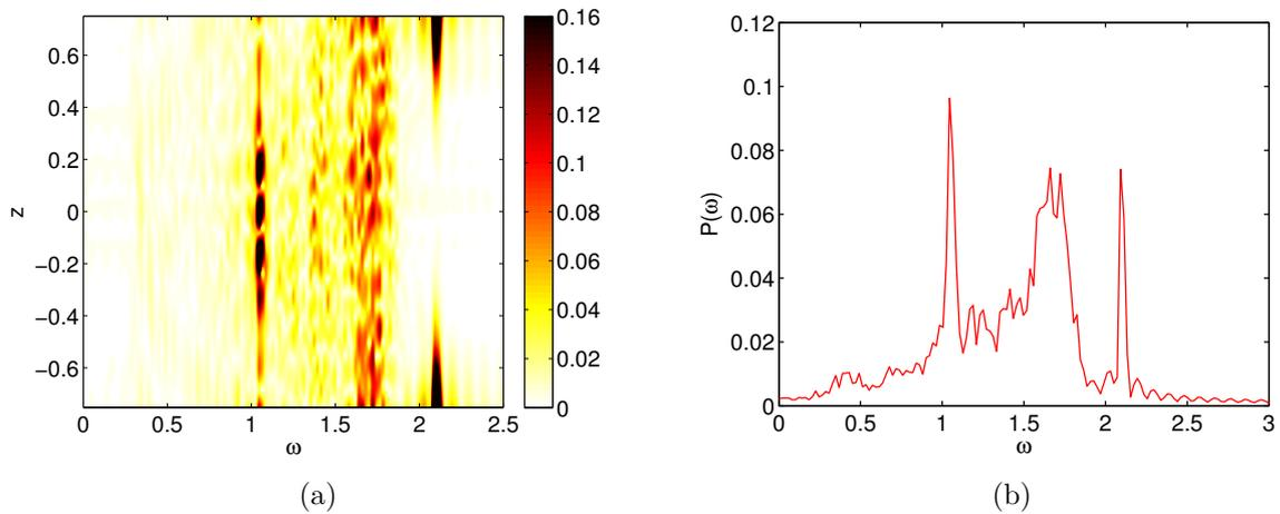
FIGURE 6.13 – (a) Spectre temporel  $P(\omega)$  de la vitesse radiale  $u_r$  pour une coupe à  $r = 0,2$  en fonction de la position axiale  $z$  pour un cylindre de rapport d'aspect  $H/R = 2$  et  $E = 4 \cdot 10^{-5}$ ,  $\varepsilon = 0,8$ ,  $\omega = 2,1$ . (b) Moyenne suivant la coordonnée axiale  $z$  du spectre temporel  $P(\omega)$  présenté sur la figure (a).
