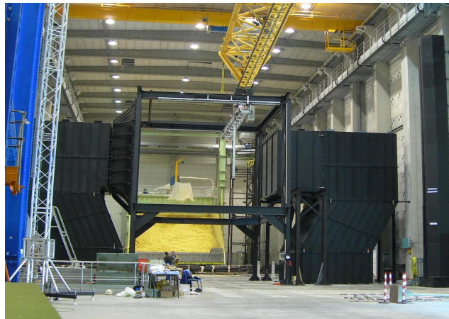
FIGURE 4.9 – Générateur de rafale au B20
