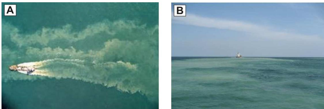
**Figure 7 : Photographies du panache de surface généré à l'arrière de la drague.**
