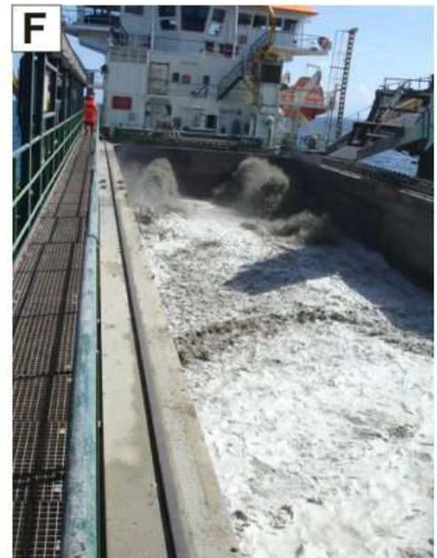
**Planche 1 A : Tête d'élinde de type « fixed visor » ; B : Tête d'élinde de type « california » ; C : Elinde équipée d'un système de jet d'eau ; D : Elinde de grande dimension ; E : Déversement par tour centrale ; F : Déversement par ouverture dans le bassin.**
