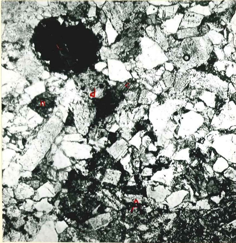
Ech. 5718 - Microbrèche . LN - x 50 - C = calcaire à Globigérine (?), c = calcite, d = dacite, A = andésite, h = hornblende brune.
