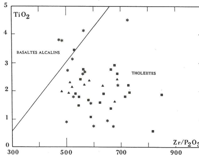
Figure 43: Diagramme Zr/P<sub>2</sub>O<sub>5</sub> - TiO<sub>2</sub> de WINCHESTER (1976) La majorité des metabasites du Versoyen se localisent dans le domaine des tholéïites. Etoiles: metabasites du Clapet; carrés: metabasites des autres régions; triangles: laves en coussins.
