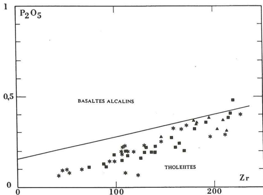
Figure 42: Diagramme Zr - P<sub>2</sub>O<sub>5</sub> de WINCHESTER & FLOYD (1976) le diagramme montre l'appartenance des metabasites du Versoyen au groupe des tholéïites. Etoiles: metabasites du Clapet. Carrés: metabasites des autres régions. Triangles: laves en coussins.
