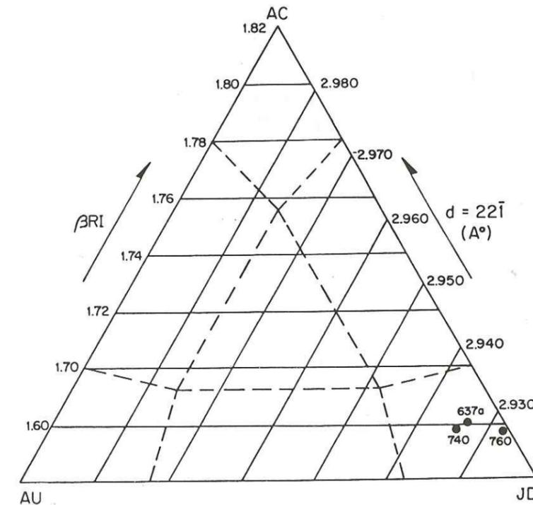
Figure 21: Diagramme triangulaire faisant intervenir l'indice de réfraction moyen (Nm) et la mesure de la raie  $\bar{2}21$ , pour l'estimation de la composition des pyroxènes sodiques, d'après ESSENE & FYFE (1967). (définition des différents domaines p.89).
