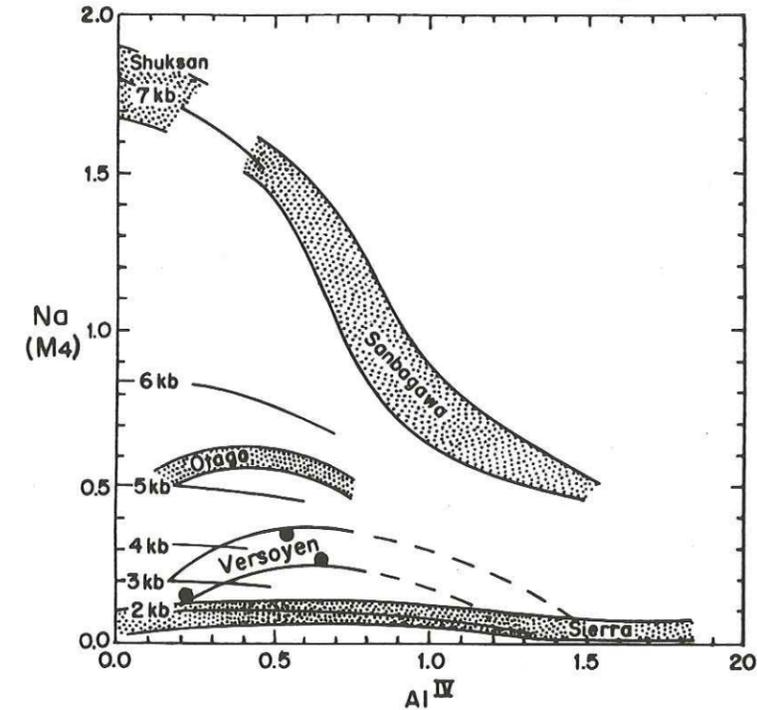
Figure 34: Diagramme Al<sup>IV</sup> - Na en M<sub>4</sub> pour l'estimation de la pression de cristallisation des amphiboles calciques métamorphiques (BROWN, 1977).
