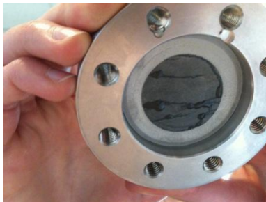
Figure 83 : Photographie de la cellule TOAR proche fissure (bleu) , montrant les microfissures à l'origine des fuites.
