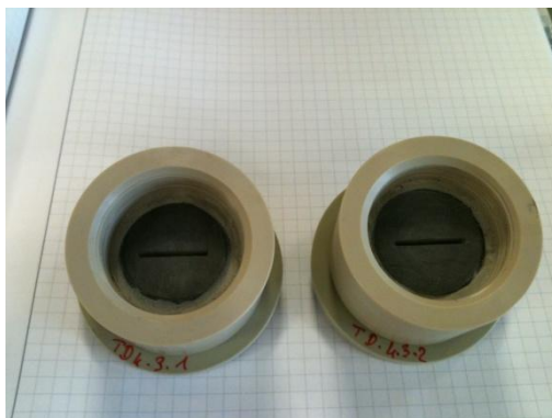
Figure 45 : Réalisation des sillons dans des échantillons provenant du TD4 en vue d'un remplissage de pâte de ciment pour les études menées à l'interface argilite-ciment.
