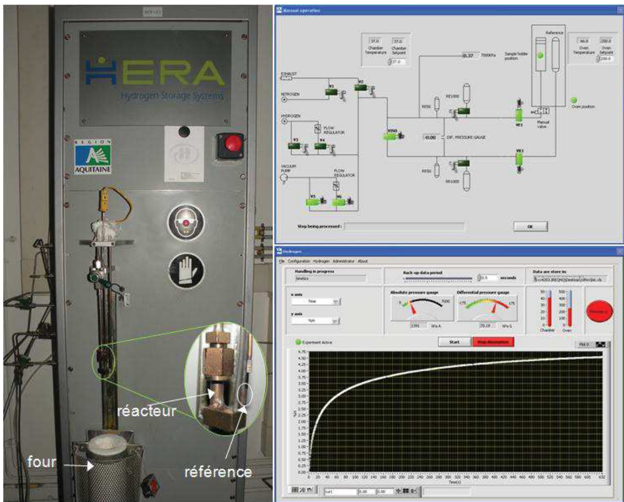
Figure II.11 Cycleur automatique HERA : photographie, schéma de fonctionnement (interface graphique, à droite) et exemple de courbe d'absorption (en bas à droite)
