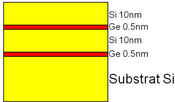
Fig. 5.8: Schéma d'un empilement de couches de Ge-Si sur substrat Si formant un super-réseau.
