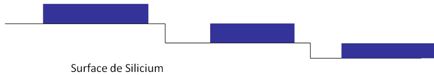
Fig. 2.12: Schéma d'un dépôt à température intermédiaire sur une couche de silicium (après dépôt), par MBE. La matière se dépose, et crée des germes cristallins sur les marches qui vont s'agrandir jusqu'à recouvrir totalement les marches. On obtient donc une couche cristalline.
