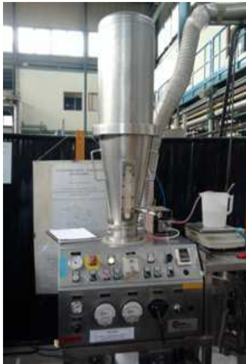
Figure III.4. Pilote d'agglomération discontinu Uni-Glatt.
