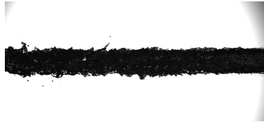
FIGURE II.1.6: Allure du jet en sortie de buse
