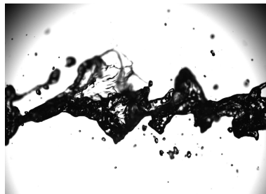
FIGURE II.1.7: Allure du jet à x/d_{buse} = 70
