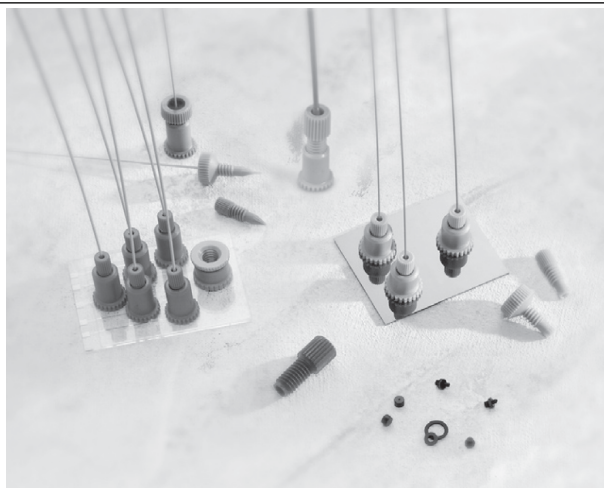
FIGURE 3.9 – Photographie présentant différentes connexions microfluidiques à l'aide des supports UpChurch [9]
