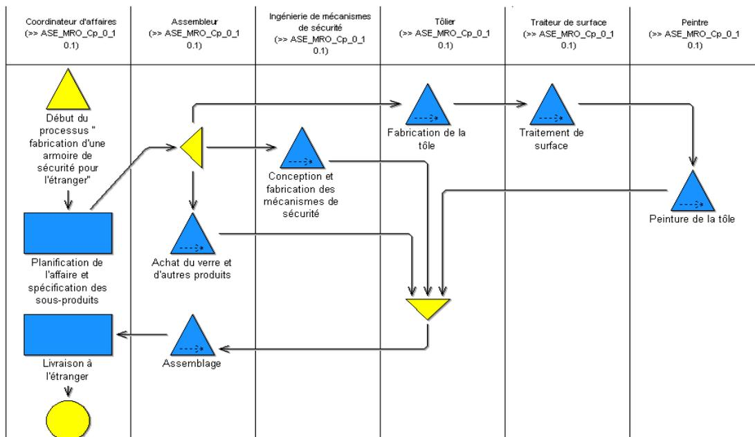
FIG. 8.12 – Modèle de conception du processus de fabrication d'une armoire de sécurité pour l'étranger (ASE\_MP\_Cp\_0\_1.FabricationASE)
