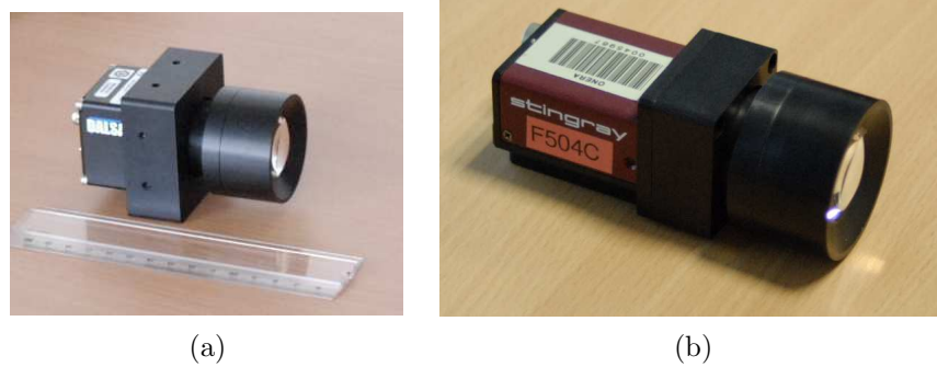
Fig. 4.16: Photographie de l'objectif chromatique co-conçu combiné : (a) au détecteur Dalsa (b) au détecteur Stingray.
