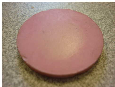
FIG. B.1 – Echantillon d'Oxyde d'Erbium fritté.
