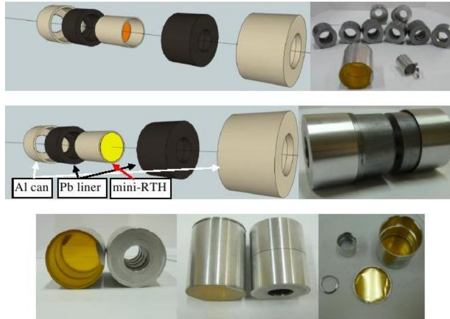
FIGURE 2.24 – Modélisation du blindage pour la cible ^{173}\text{Lu} et photos des différentes parties constituant le blindage.
