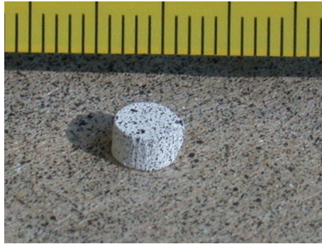
Figure 49 – Exemple de pastille de PBHT mouchetée utilisée pour nos essais
