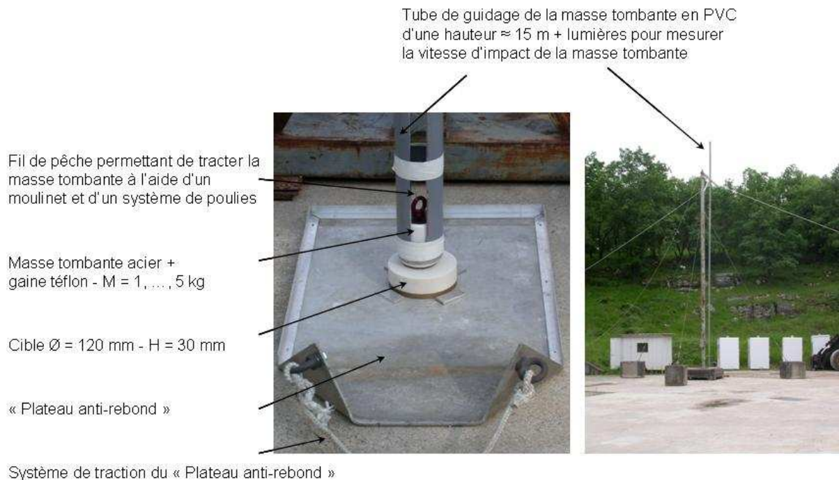
Figure 97 – Dispositif tour de chute grande dimension
