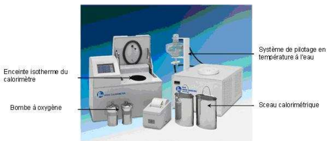
Figure 103 – Calorimètre de combustion isopéribole Parr 6200 avec sa bombe à oxygène et son seau de refroidissement
