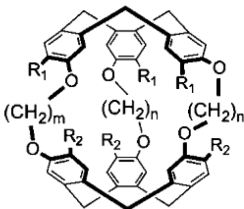
Figure 5-5 : Structure générale d'un cryptophane avec n et m les longueurs de chaîne reliant les 2 CTB et R_1 et R_2 les substituants des cycles aromatiques en ortho des oxygènes.
