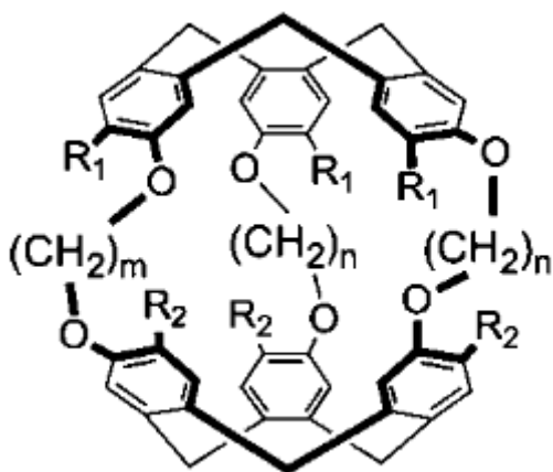
Figure 5-5 : Structure générique d'un cryptophane avec n et m les longueurs de chaîne reliant les 2 CTB et R_1 et R_2 les substituants des cycles aromatiques en ortho des oxygènes.
