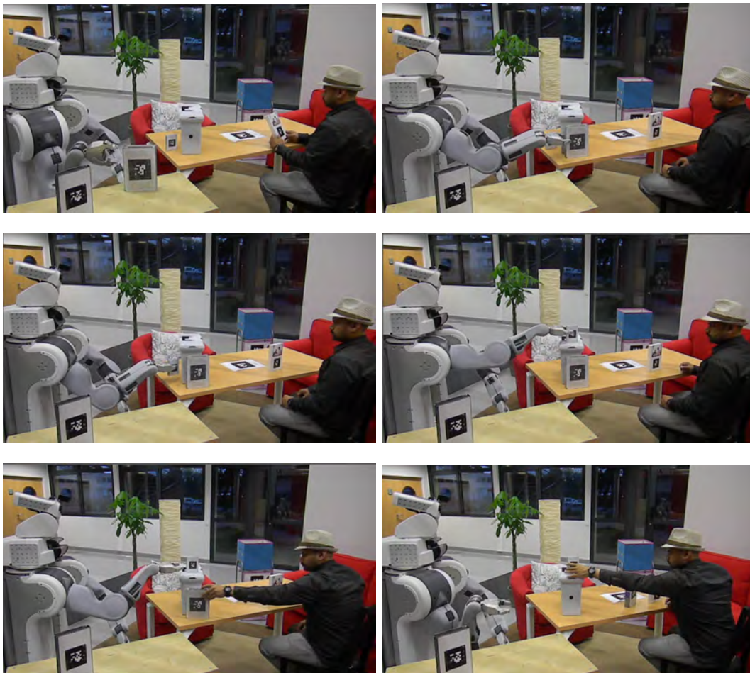
Figure E.21: Tâche : rendre accessible:Placement stable sur un autre objet, assurant un effort minimal de l'homme: (a)-(f) row-wise: PR2 rend accessible de manière séquentielle deux objets à l'homme. Le premier objet sur la droite n'est pas accessible par l'homme de sa position et le second objet est derrière la boîte d'un point de vue de l'homme et visible de l'homme à partir de sa position courante. La planificateur trouve de manière autonome un placement pour le 1er objet (b). Il trouve également un placement stable pour le second sur la boîte (e) ce qui assure un effort minimum pour l'homme pour le prendre Arm_Torso_Effort (e) et (f).
