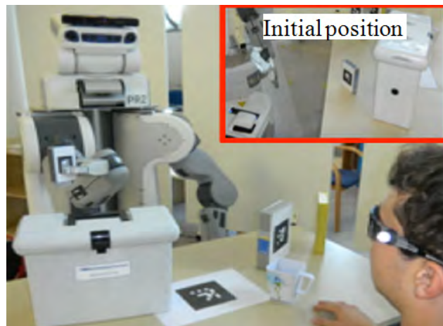
Figure E.16: Tâche : montrer un objet : maximiser la visibilité, maintenir l'objet devant et en haut: PR2 montrant l'objet avec une orientation qui permet de le rendre le plus visible possible vis à vis de l'homme.
