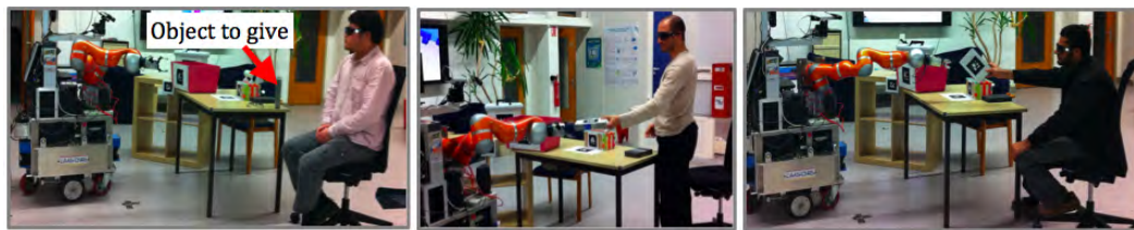
Figure E.29: Scénario pour une tâche où l'homme doit donner un objet au robot. (a) En l'absence de comportement pro-actif, l'homme est debout et vient vers le robot ( Whole_Body_Effort ) pour donner l'objet. (b) Avec un comportement pro-actif, l'homme donne l'objet au robot en faisant uniquement un mouvement du bras Arm_Effort .
