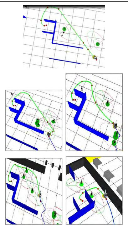
Figure E.9: (a) plan initialement calculé par notre planificateur. (b) Détection d'un groupe, contournement par la gauche du groupe. (c) Détection d'une personne, contournement par la gauche de la personne. (c) Overtaking a person from his left (d) Détection de plusieurs personnes. Contournement par leur droite. (e) Détection d'une personne dans un couloir. Contournement. On notera que l'aspect lisse et régulier des trajectoires recalculées.
