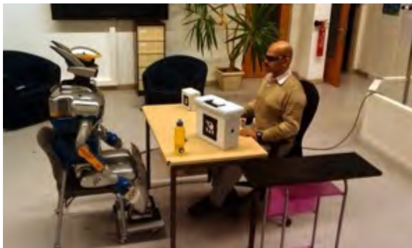
Figure E.6: Interaction face à face entre HRP2 et un homme dans le cadre de réalisation de tâches interactives
