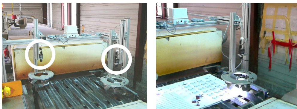
(a) 2 caméras monochromes matricielles (cerclées en blanc) font l'acquisition
