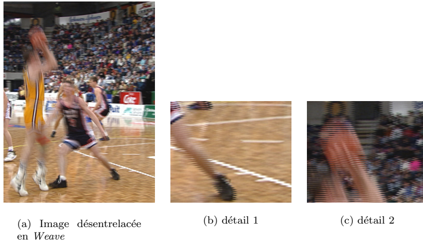
FIGURE 6.1 – Exemple d’une vidéo affichée sur un écran progressif avec un désentrelacement de type Weave où deux trames successives sont combinées pour former l’image entière. On aperçoit très bien l’effet de peigne dû au mouvement de la caméra ou des joueurs entre les deux trames acquises à 20ms d’intervalle
