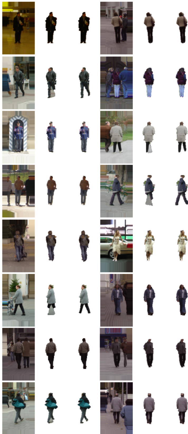
FIGURE 5.5 – De gauche à droite : image initiale, segmentation obtenue avec un gabarit unique puis avec un gabarit par parties. Dans la plupart des cas, la segmentation est plus précise avec le gabarit par parties.
