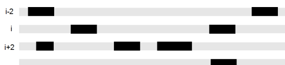
FIGURE 6.5 – Exemple de segments extraits du même type (en noir). Les lignes grises sont connues, les lignes blanches sont à interpoler
