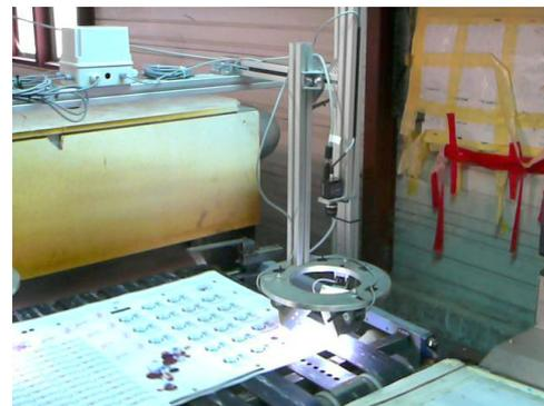
(b) le système de contrôle, synchronisé avec le passage de la feuille flashe et analyse la mire en temps réel
