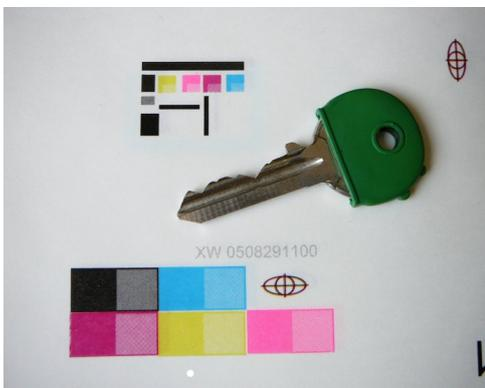
(a) en bas, l'ancienne mire pour le contrôle visuel. En haut, la mire pour le contrôle par caméra
