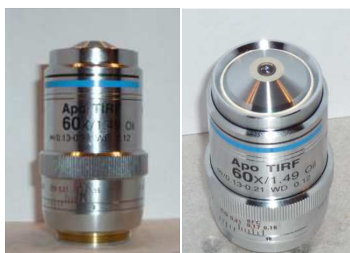
FIG. 3.2 – Objectif Nikon, 60\times , O.N. = 1,49 utilisé dans cette étude. L'ouverture numérique de 1,49 dans l'huile permet de sonder les échantillons jusqu'à des angles de 80^\circ .
