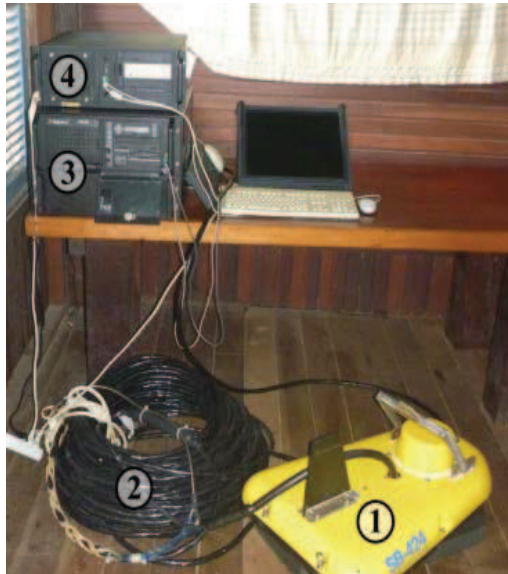
Figure 2.5 : Appareil émetteur (1); câble (2); Ordinateur de contrôle FS-SB System et amplificateur (3); Ordinateur d'acquisition (4)
