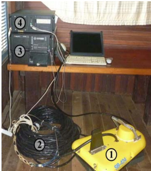
Figure 2.5 : Appareil émetteur (1); câble (2); Ordinateur de contrôle FS-SB System et amplificateur (3); Ordinateur d'acquisition (4)
