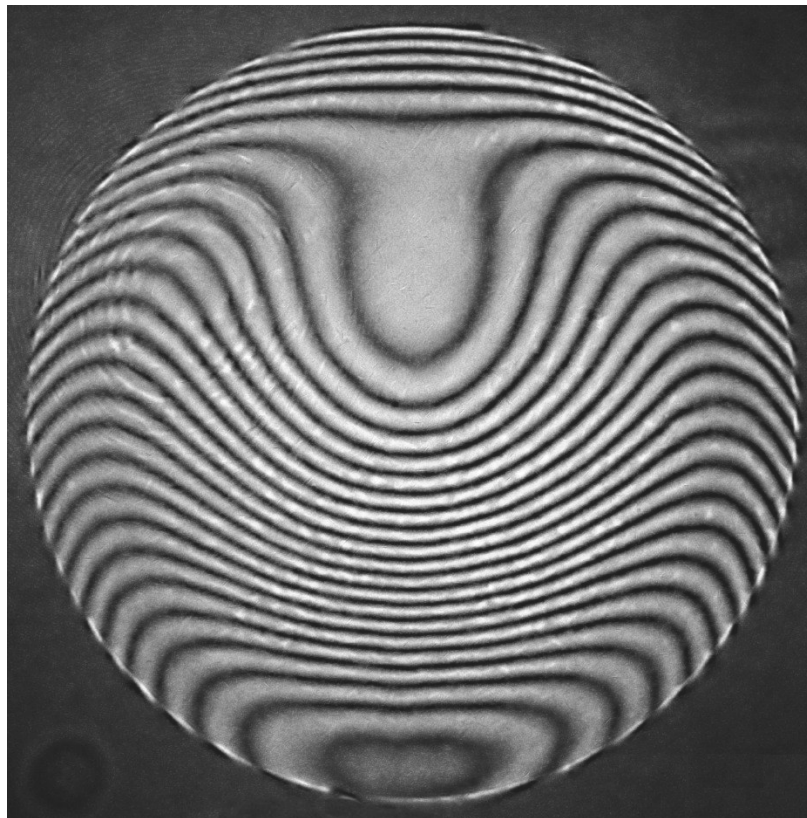
Figure AII.13 : interférogramme d'un dioptre asphérique trop complexe pour être interpréter.
