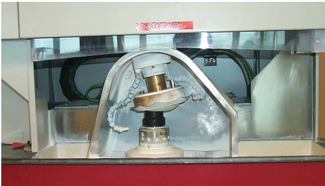
Figure I.14 : machine à commande numérique de polissage souple avec un polissoir à membrane élastique.
