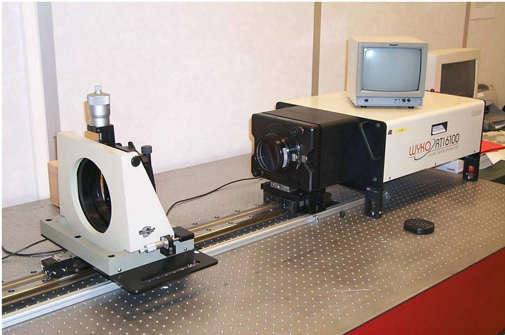
Figure II.10 : banc de mesures de dioptries sphériques par interférométrie <sup>[59]</sup>.
