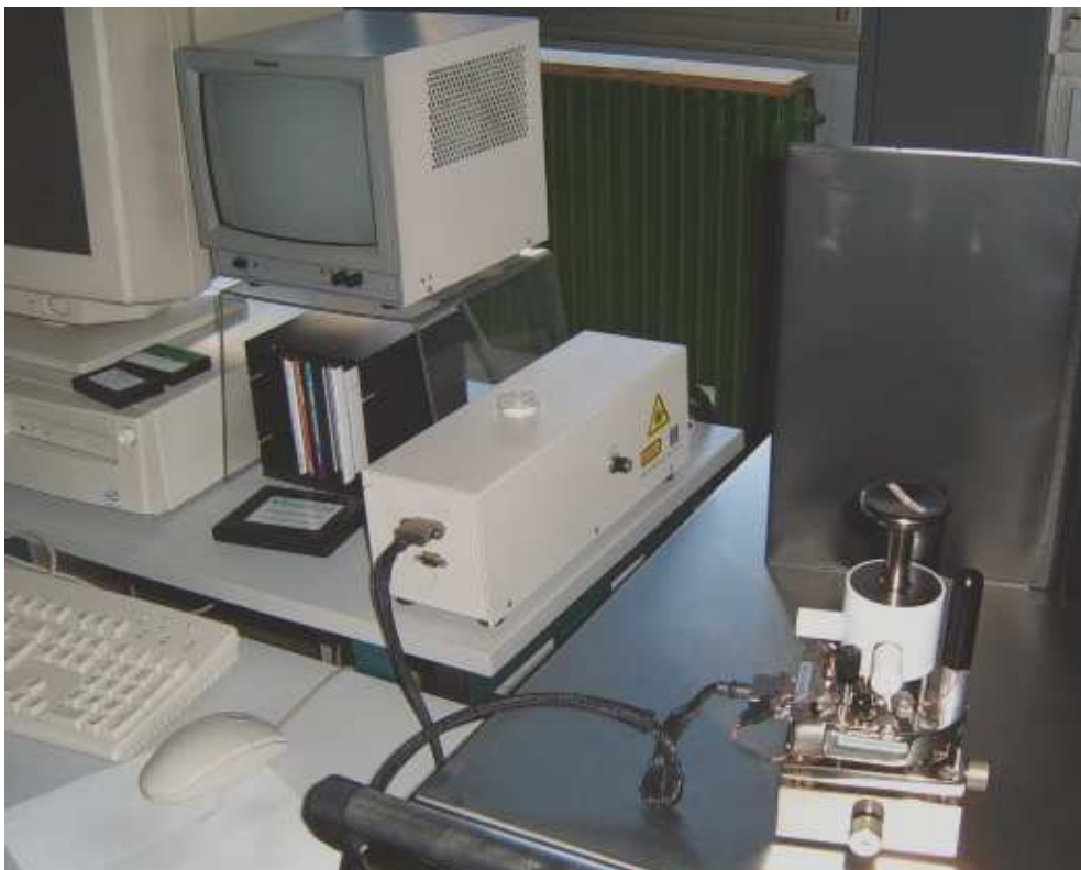
Figure AII.6 : microscope à force atomique Explorer de la société Thermomicroscopes.
