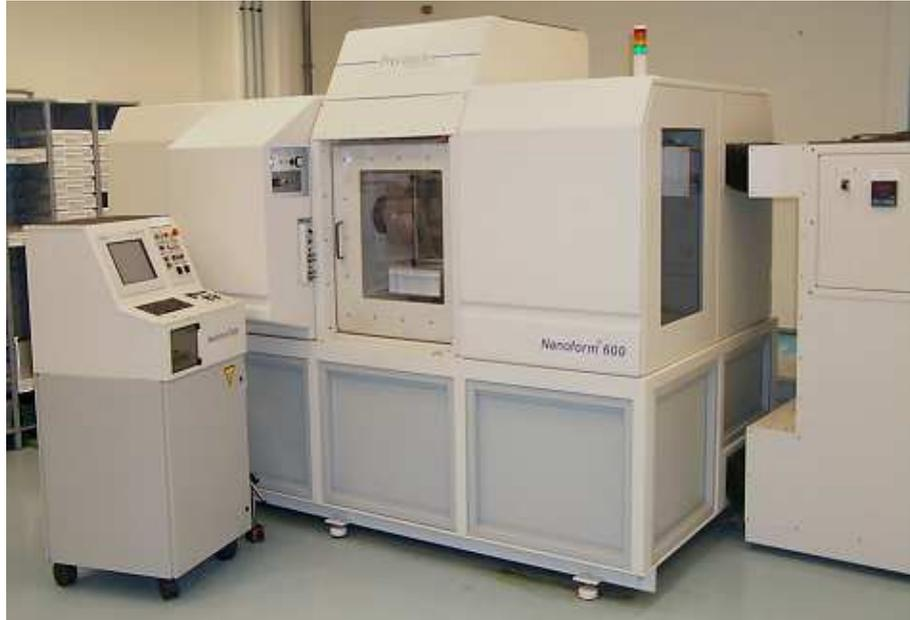
*Figure I.7 : tour de très grande précision Nanoform 600 de Precitech pour le tournage à l'outil diamant et la microrectification.*
