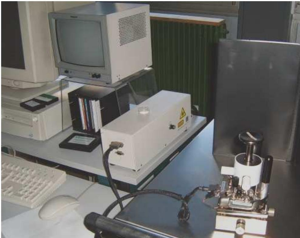
*Figure AII.6 : microscope à force atomique Explorer de la société Thermomicroscopes.*
