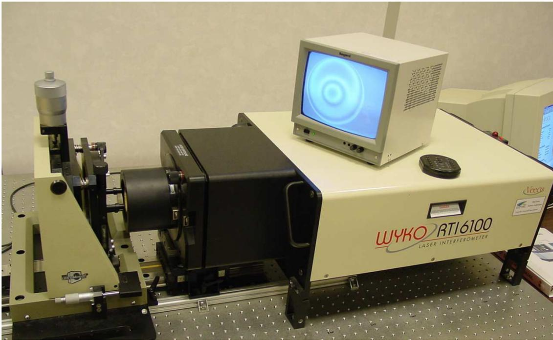
Figure AII.9 : interféromètre Wyko RTI 6100 de Veeco<sup>[59]</sup> à décalage de phase lors d'une mesure en teinte plate.
