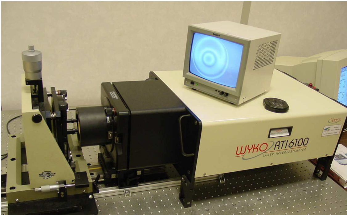
Figure AII.9 : interféromètre Wyko RTI 6100 de Veeco [59] à décalage de phase lors d'une mesure en teinte plate.
