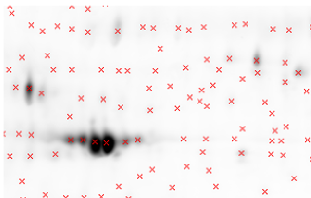
Figure 46: Visualisation de la détection des centroïdes des taches protéiques sur un détail d'une image de gel d'électrophorèse.
