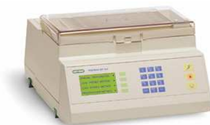
Figure 3: Photo du matériel utilisé au laboratoire de protéomique de bioMérieux pour l'électrofocalisation (Bio-Rad PROTEAN™ IEF Cell)
