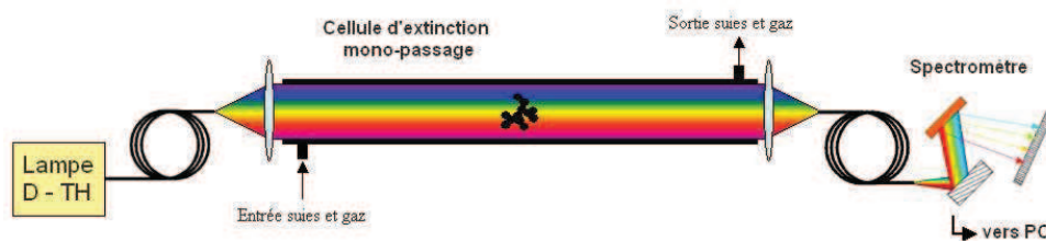
FIGURE II.14 – Schéma du dispositif de turbidimétrie
