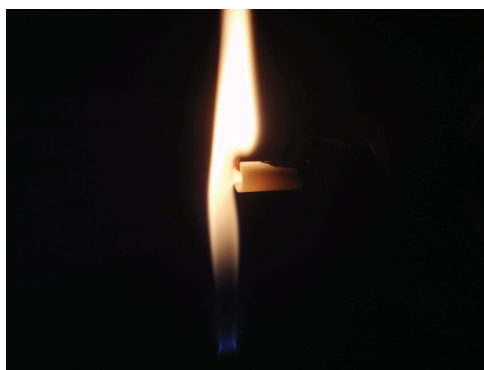
FIGURE II.1 – Prélèvement dans une flamme de kérosène avec un embout en céramique - image Maugendre (2009)
