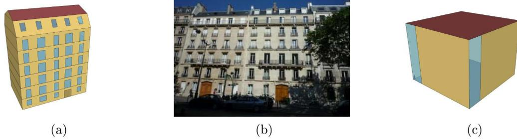
FIGURE 2.7 – Modèle détaillé (a) d'un bâtiment type Haussmannien (b) et son équivalence simplifiée (c) dans les travaux de [Bueno et al. \(2011b\)](#) source : [Bueno et al. \(2011b\)](#)
